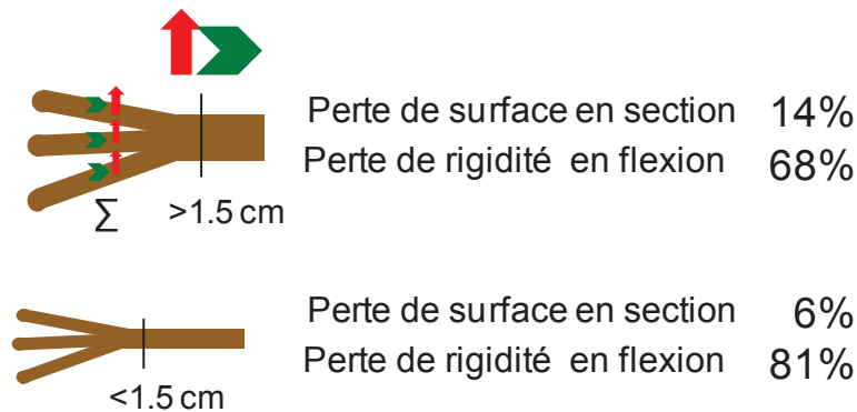
Fig. 2 Somme des surfaces en section et de la rigidité en flexion après une réitération pour des racines de 2 classes de diamètres avant la réitération. En rouge : traction, en vert : la flexion.
