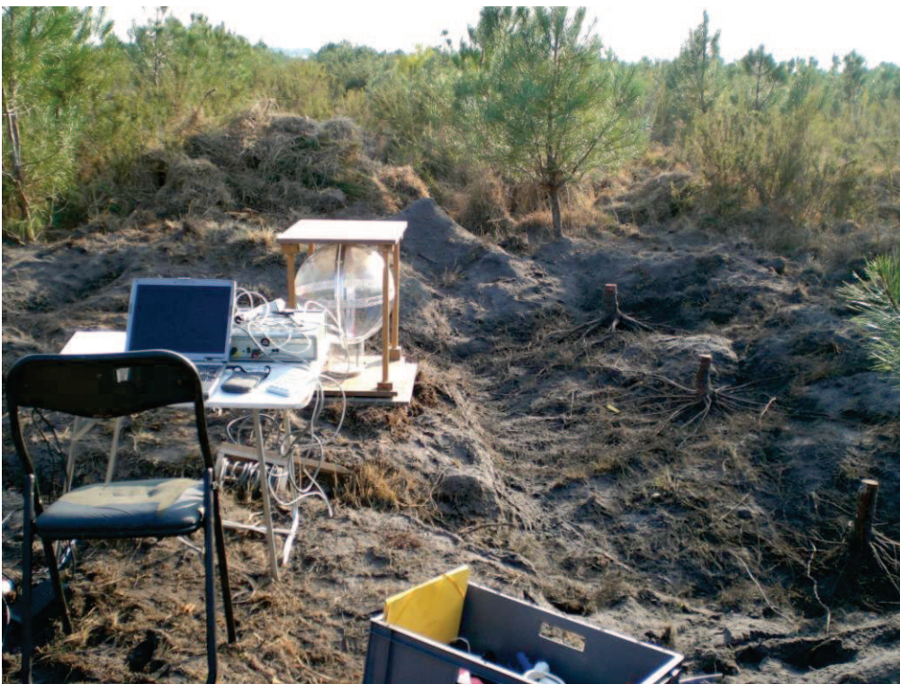
Fig. 2 Numérisation in situ du niveau du sol, de l'altitude des racines traçantes et des pivots secondaires. Second plateau des arbres de 5 ans de St Jean d'Illac. La partie superficielle du sol a été enlevée à la lance à air.
