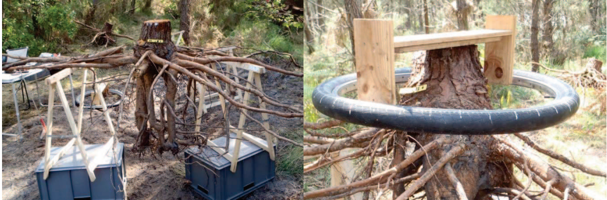
Fig. 3 Préparation d'un arbre à "raciporter". Dans un premier temps, l'arbre est surélevé et mis à l'horizontale, puis une roue graduée est placée en son centre.
