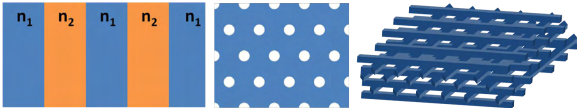
FIGURE 2.1 – De gauche à droite, exemples de cristaux photoniques 1D, 2D et 3D
