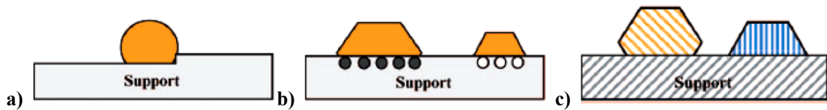
Figure 17 : Schéma de particules de la phase active ancrées a) par une barrière physique, b) par la présence de défauts et d'impuretés et c) par épitaxie, d'après [53].
