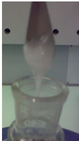
Figure 2.5.5.1. Observation de la gélification lors du greffage.
