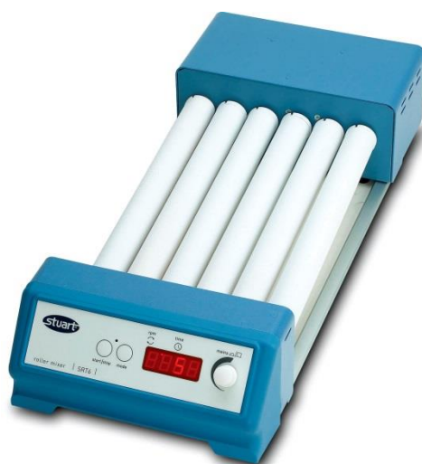
Figure 3.8.2.1. Agitateur basculant de type Rock'n Roll (Stuart Roller Mixer SRT9D) utilisé pour la granulation aqueuse
