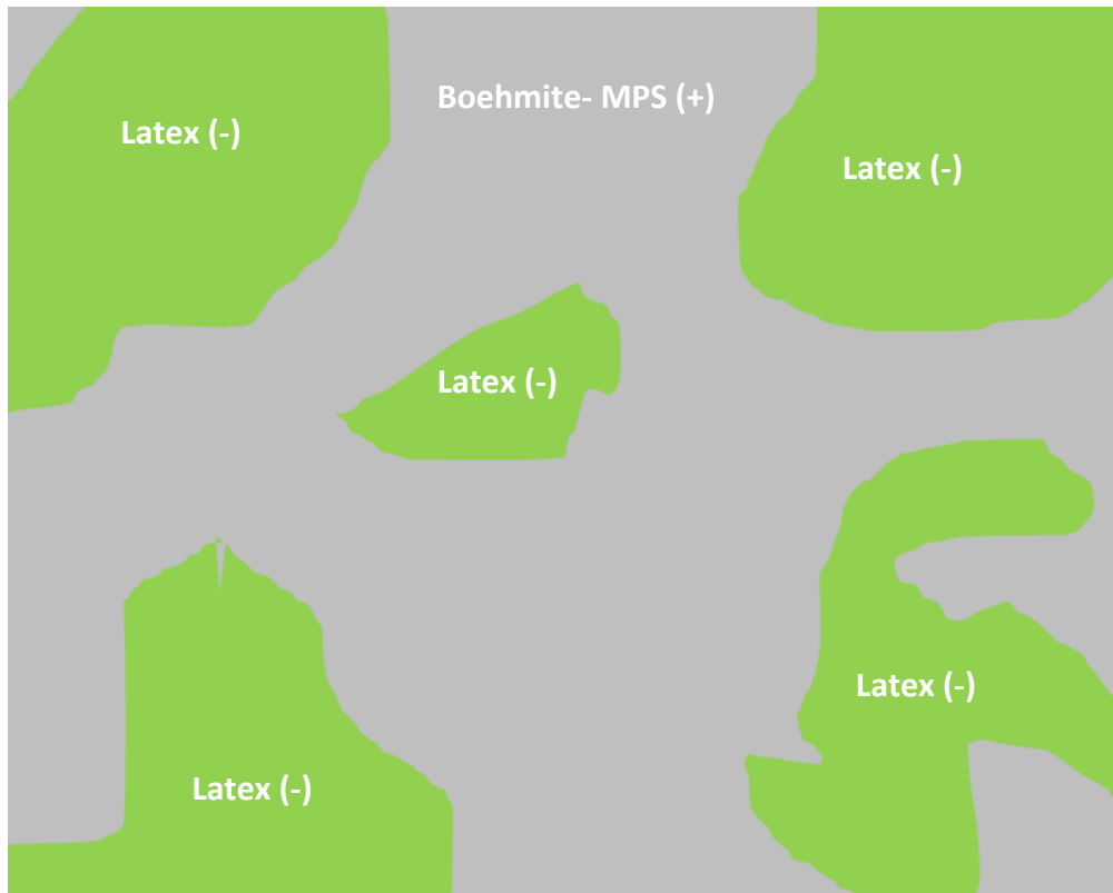
Figure 3.8.1.1 Schéma représentant la surface de l'hybride boehmite-MPS-Latex.
