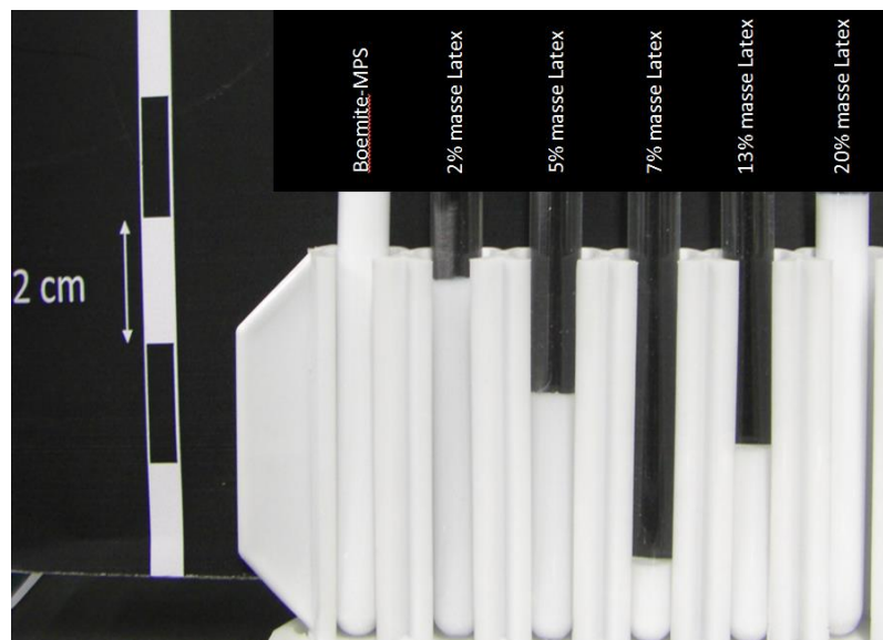
Fig.3.5.2. Test de sédimentation des suspensions contenant des agrégats de boehmite enrobés par différentes quantités de styrène, le pH de toutes les suspensions est fixé à 3.
