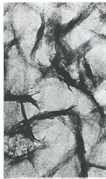
Figure 1.7.1.1 Cliché MEB des nanofilaments d'Alumine[70]
