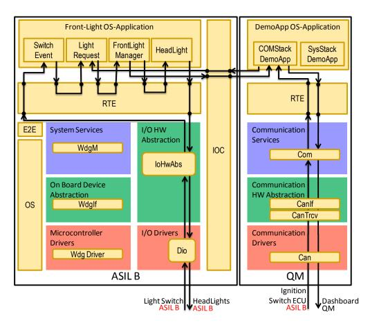
FIGURE 5.5 FRONT-LIGHT SOFTWARE ARCHITECTURE
