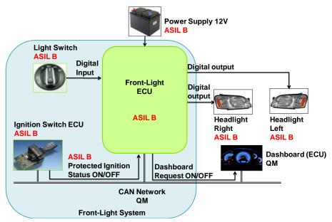
FIGURE 5.1 ARCHITECTURE OF THE FRONT-LIGHT SYSTEM
