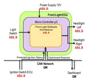
FIGURE 5.2 ARCHITECTURE OF THE FRONT-LIGHT ECU
