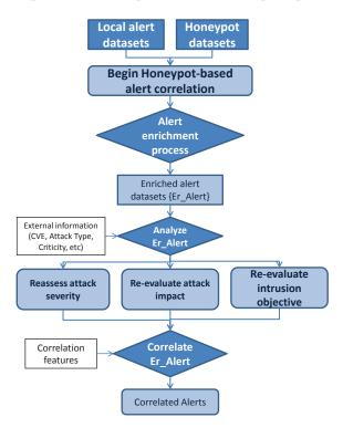
FIGURE A.2 - Processus de corrélation d'alertes basée sur les pots de miel.
