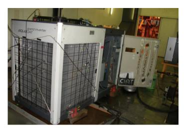
Figure 3.1 – Prototype de la machine frigorifique (source : CIAT)
