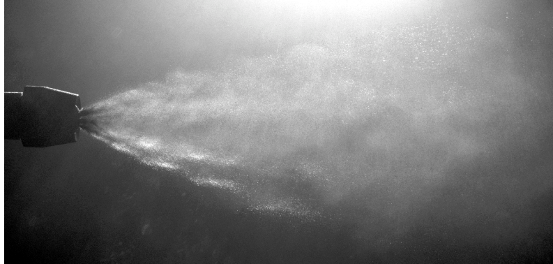
FIGURE 5.19 – Visualisation par tomographie du spray généré par l’injecteur industriel de 2 MW pour un débit de fioul \dot{m}_f = 198 \text{ kg} \cdot \text{h}^{-1} . Image réalisée par Paubel (2009) .
