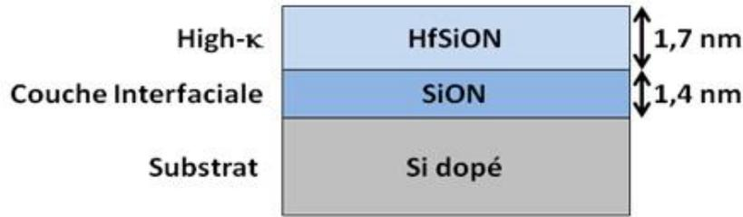
Figure 1.7 : Schéma de l'oxyde de grille High-k utilisé pour le transistor du nœud 28nm. L'oxyde possède une structure bicouche en raison de la couche interfaciale nécessaire pour les performances du dispositif.
