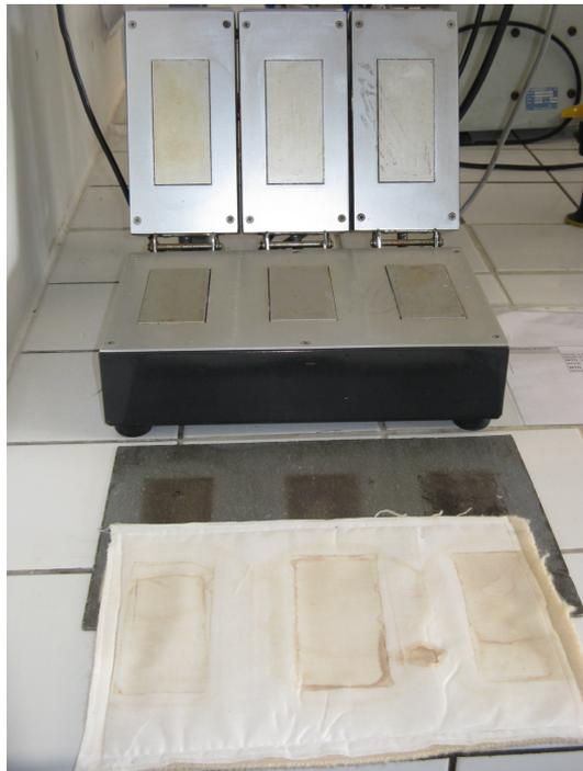
*Figure 4 - 7 : Photo du dispositif thermique, de la feuille résistante à la chaleur sur laquelle est déposée la flanelle de laine recouverte par un tissu de coton non teint utilisés pour les essais de solidité au repassage à chaud.*
