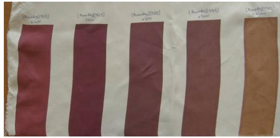
Figure 2 - 39 : Photo des échantillons AuAg(95/5) x 100, x 200, x 300, x 500 et x 1000 après impression, fixage et lavage
