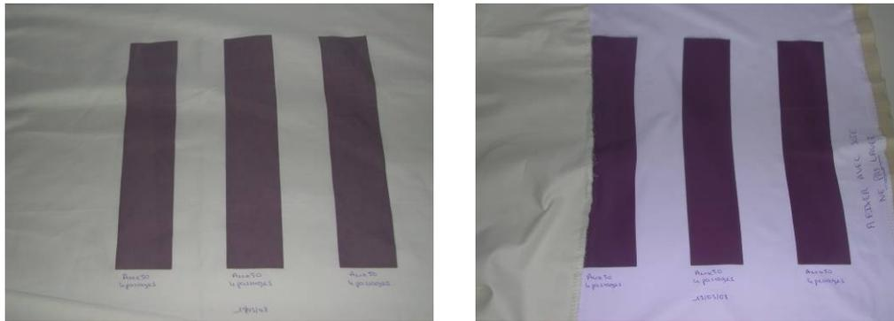
*Figure 2 - 21 : Photos des résultats obtenus avec une impression de type Au x 50 sur coton (à gauche) et polyamide (à droite)*
