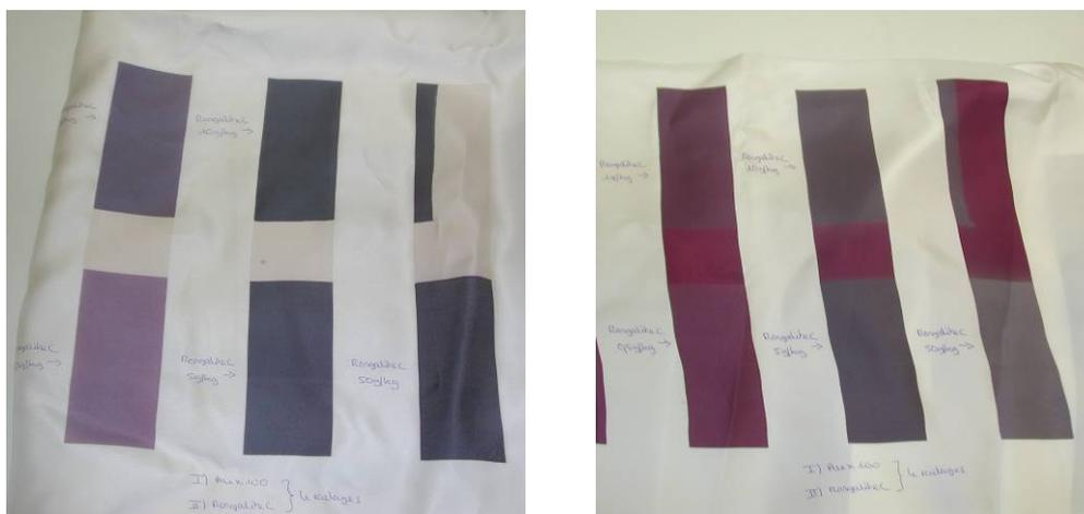
Figure 2 - 12 : Photos de réduction directe de sel d'or de type Au x 100 par différentes concentrations de Rongalite C non fixé (à gauche) et fixé (à droite)
