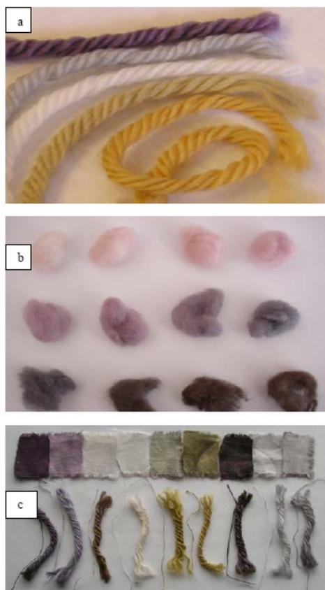
*Figure 1 - 34 : Echantillons de laine et de coton colorés par des nanoparticules d'or*
