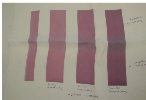
Figure 2 - 14 : Photo des essais de réduction directe à partir de solutions Au x 30, x 50 et x 100 complexées par un large excès d'ammoniac, pour des concentrations de 0,05 et 0,025 g/kg de Rongalite C
