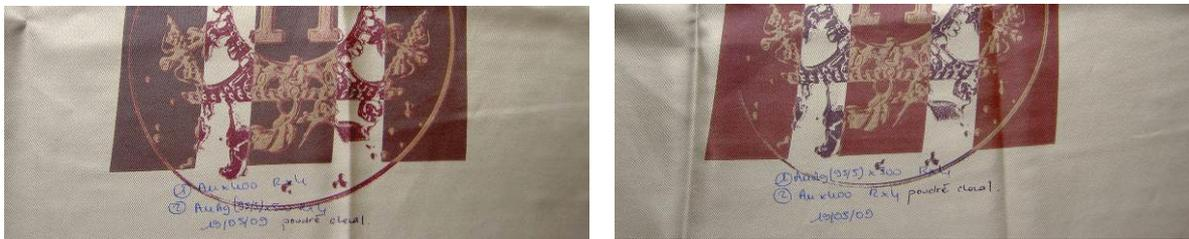
*Figure 3 - 9 : Photos de superposition d'un dessin de composition AuAg(95/5) x 500 sur des mats de composition Au x 400 avec effet irisé (à gauche) et de superposition d'un dessin de composition Au x 400 sur des mats de composition AuAg(95/5) x 500 avec effet irisé (à droite)*
