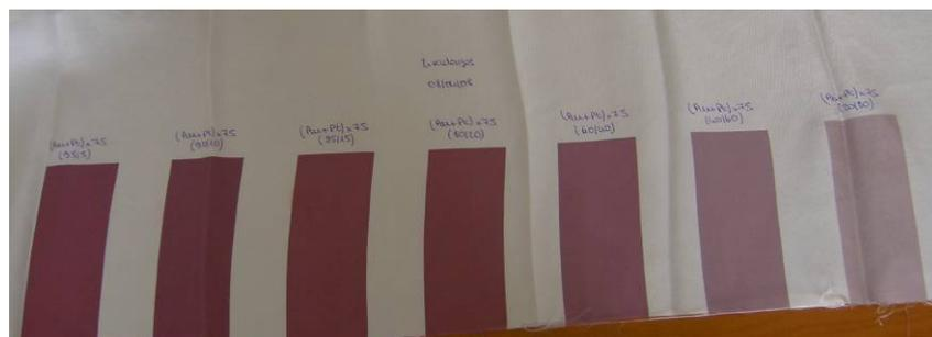
Figure 2 - 35 : Photo des échantillons de type AuPt x 75 avec 5%, 10%, 15%, 20%, 40%, 60% et 80% de platine
