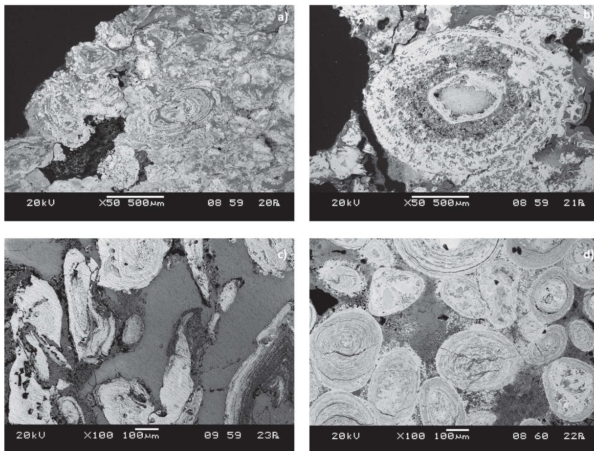
**Figure 69.** *Micrographies d'altérites de roche glauconieuse – faciès oolithes ; oolithes ferrugineuses, prises dans un ciment carbonaté ; a : JVP-AP-Bloc-528 ; b : JVP-AP-Bloc-548 ; c : JVP-AP-Bloc-704 ; d : JVP-AP-Bloc-767 (clichés J.-V. Pradeau).*
