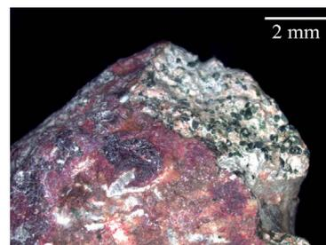
**Figure 60.** *JVP-AP-Bloc-772 : marcassite (fraction à gauche) et glauconite saine (grains verts en haut à droite (cliché J.-V. Pradeau).*
