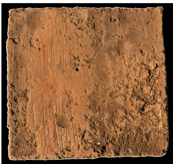
Figure 148. Expérimentation – plaque céramique rayée suite à l'abrasion avec un bloc de bauxite (cliché J.-V. Pradeau)
