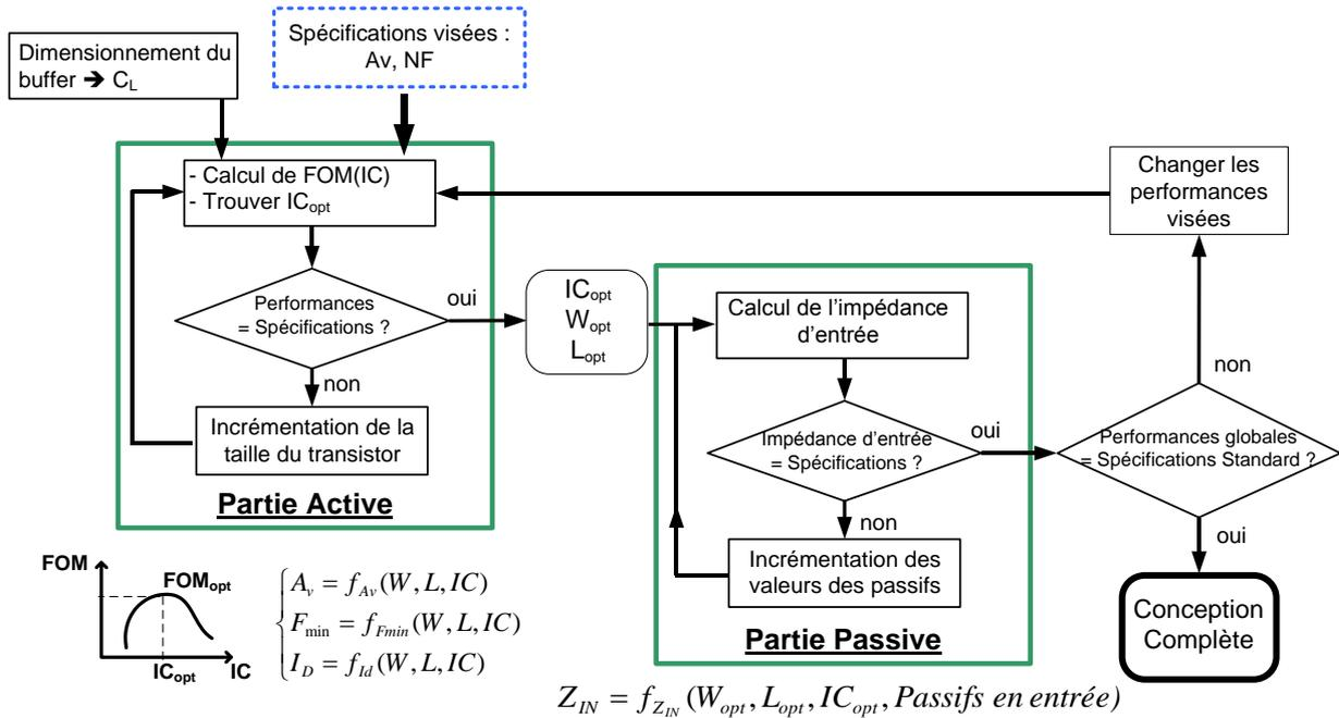
Figure III-18 Diagramme de conception du circuit complet
