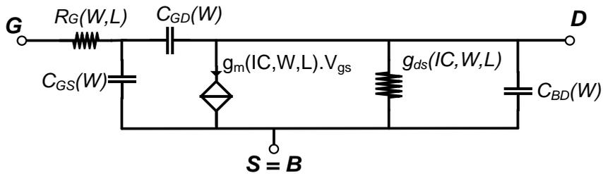
Figure II-14 : Modèle petit signaux normalisé du transistor MOS
