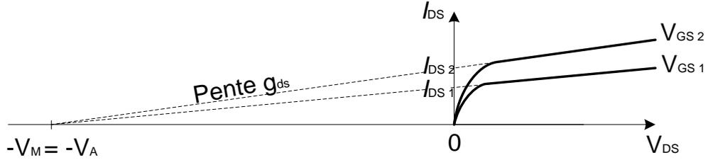
Figure II-9 Convergence de la caractéristique ( $I_D$ - $V_{DS}$ ) en saturation vers ( $-V_M$ ).
