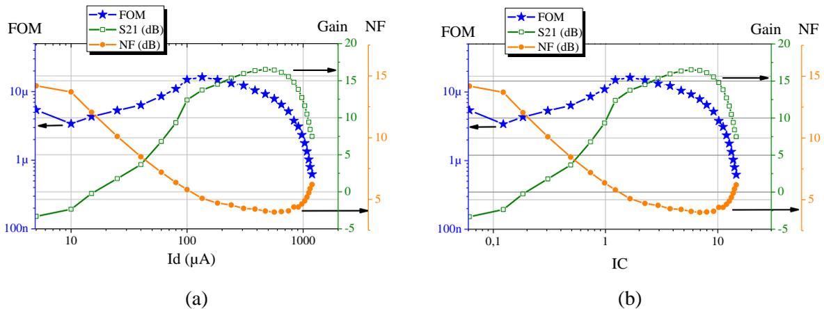
Figure III-40 Performances du circuit à 2,4GHz en fonction : du courant de polarisation (a) et le coefficient d'inversion (b)
