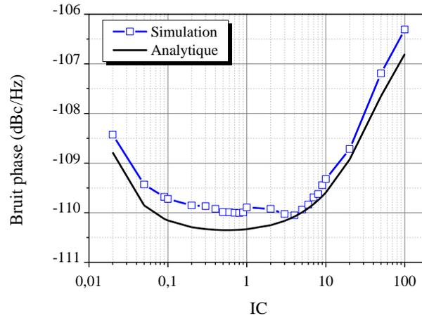
Figure IV-7 Bruit de phase à 1MHz d'une porteuse à 2,4GHz en fonction du coefficient d'inversion pour une amplitude fixe de 100mV
