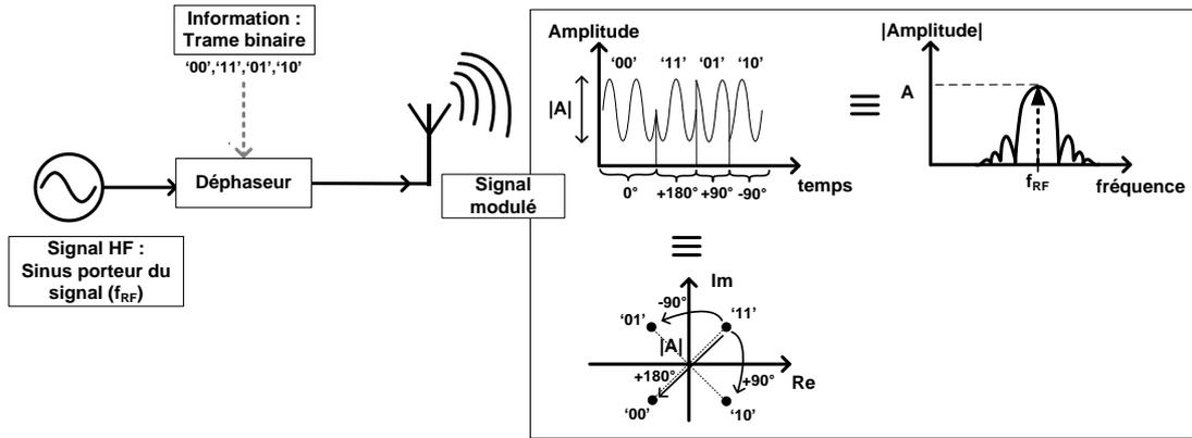
Figure I-5 Exemple de modulation de phase numérique QPSK.
