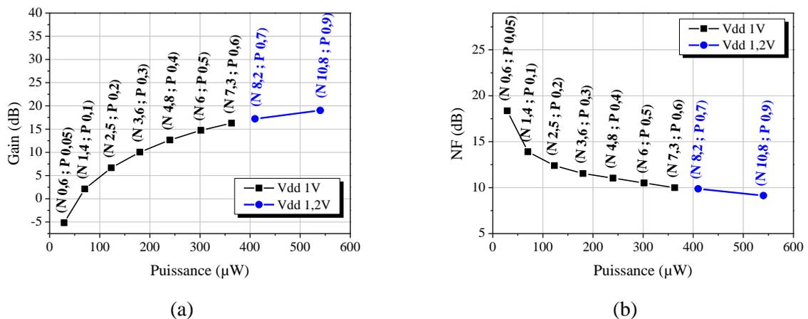
Figure III-33 Performances en gain (à gauche) et en bruit (à droite) en fonction de la puissance consommée pour le LNA n°2 à 2,4GHz avec les valeurs numériques d'IC du NMOS et PMOS
