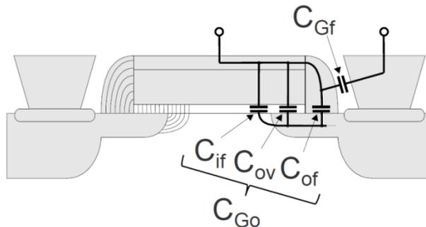
Figure B-3 Capacités parasites extrinsèque du transistor MOS
