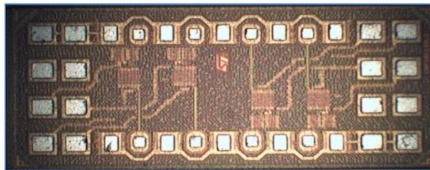
Figure III-26 Photographie de la puce en CMOS 28nm
