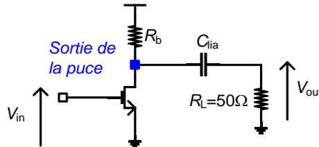
Figure III-17 Buffer : Source commune à charge résistive
