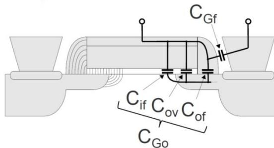
Figure II-13 Capacités parasites extrinsèque du transistor MOS
