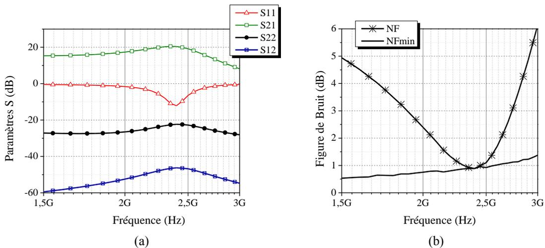
Figure III-22 Simulation des paramètres S (a) et de bruit (b) pour le circuit n°1 à 120µW
