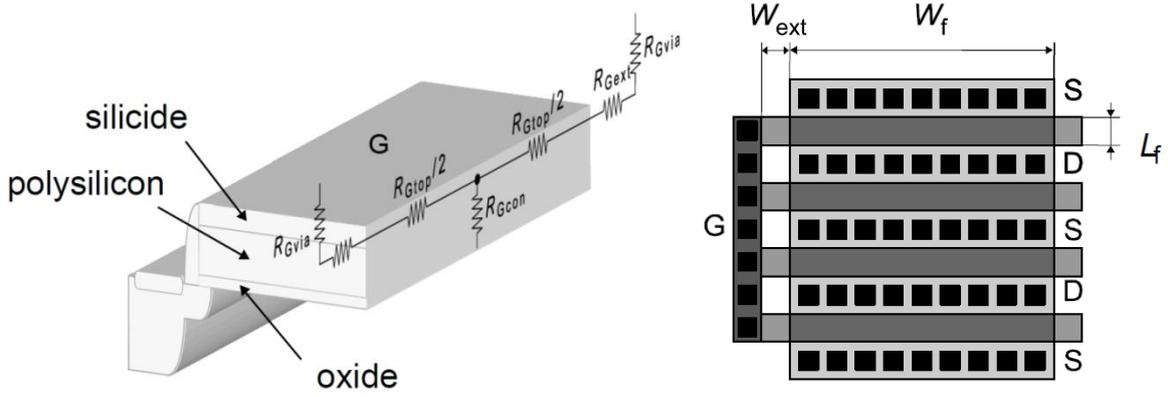
Figure B-2 Vue en coupe de la grille et son équivalent électrique (à gauche) et vue de dessus d'un transistor à plusieurs doigts (à droite).
