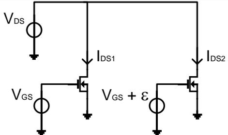
$g_m = \frac{dI_{DS}}{dV_{GS}} = \frac{I_{DS2} - I_{DS1}}{(V_{GS} + \epsilon) - V_{GS}} = \frac{I_{DS2} - I_{DS1}}{\epsilon}$ <p style="text-align: center;">Avec <math>\epsilon \rightarrow 0</math></p> <p style="text-align: center;">(b)</p> |
