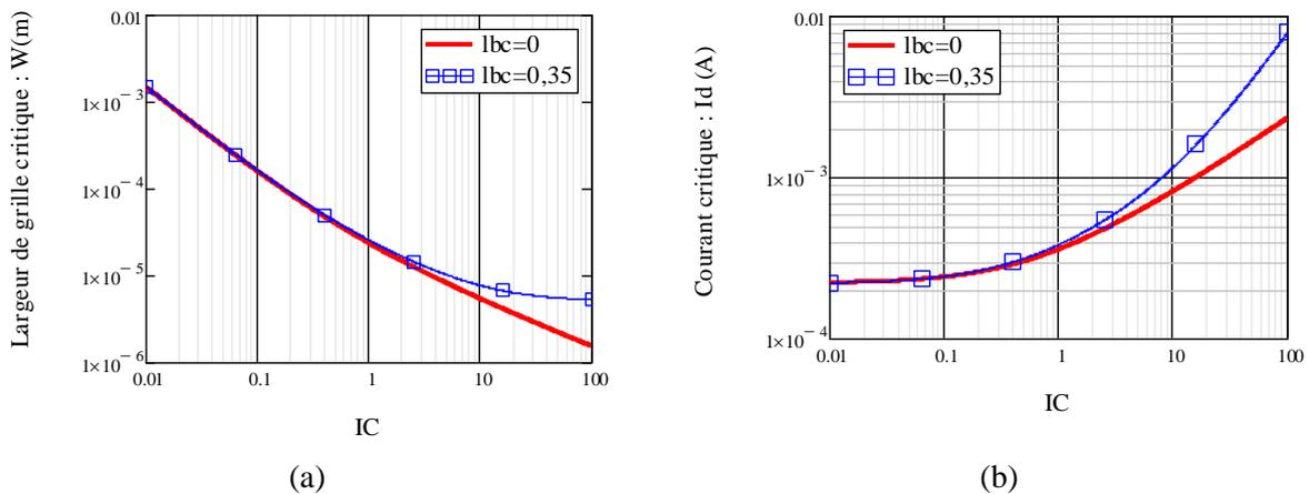
Figure IV-3 Evolution de la largeur de grille critique  $W_{crit}$  (a) et du courant critique  $I_{D\_crit}$  (b) en fonction du coefficient d'inversion, avec ( $\lambda_c=0.35$ ) et sans ( $\lambda_c=0$ ) influence de la saturation de vitesse des porteurs
