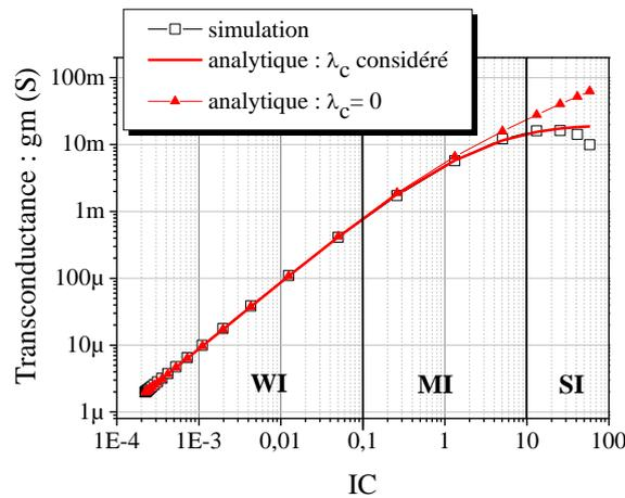
Figure II-7 Comparaison de la transconductance en simulation et analytique avec et sans facteur de saturation de vitesse des porteurs pour un transistor de taille  $W = 6\mu\text{m}$  et  $L=30\text{nm}$ .
