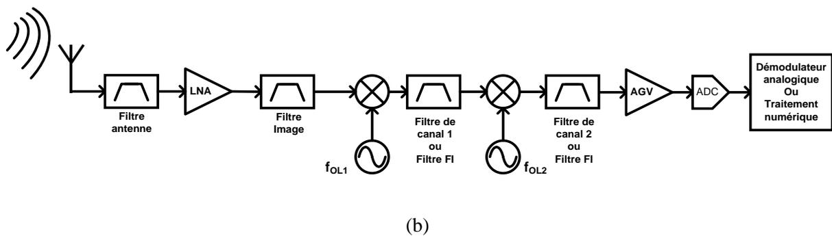
Figure I-8 Architecture d'une réception superhétérodyne à simple (a) et double (b) conversion
