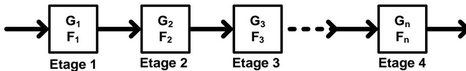
Figure I-17 Système à n étage en cascade
