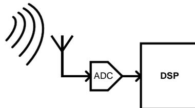
Figure I-12 : Cas idéale de réception Radio-logicielle
