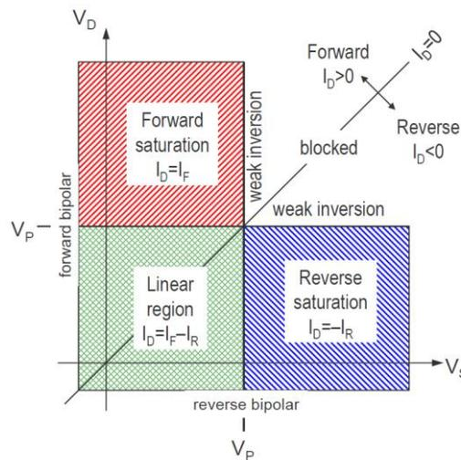
Figure II-3 Différents modes de polarisation en régime d'inversion
