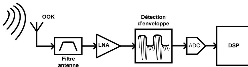
Figure I-14 : Exemple d'architecture WSN à détection d'enveloppe
