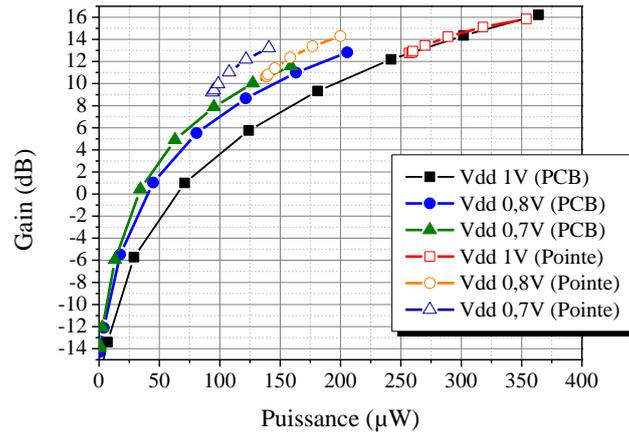
Figure III-32 Mesure du gain du LNA n°2 à 2,4GHz en fonction de la puissance consommée pour différents Vdd et comparaison des deux types de mesures.
