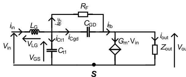
Figure F-7 Schéma petits signaux pour le calcul de l'impédance d'entrée
