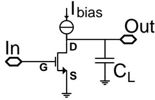
Figure III-1 Circuit : source commune à charge capacitive
