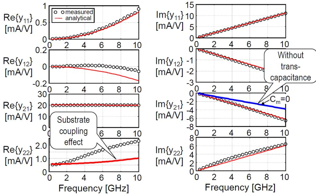
Figure D-2 Extraction des paramètres  $Y_{ij}$  [1] [2]: comparaison entre mesures et résultats analytiques pour un transistor NMOS avec :  $W=12\mu\text{m}$ ,  $L=0.36\mu\text{m}$ , 10doigts,  $V_G=1\text{V}$  et  $V_D=1\text{V}$ .
