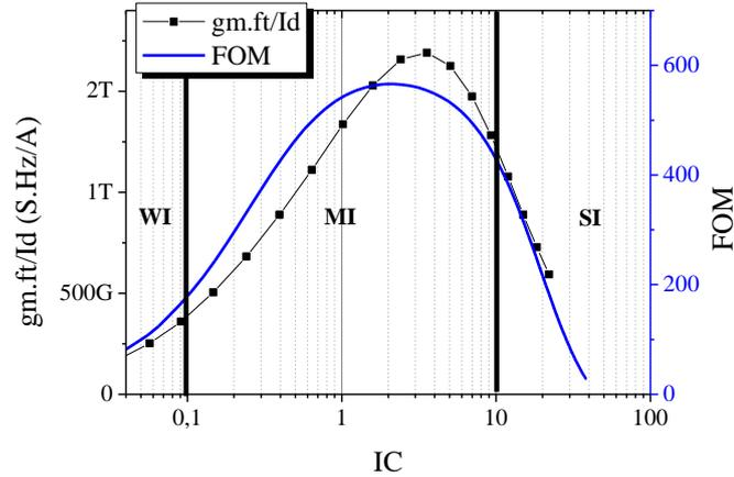
Figure III-3 Résultats de simulation sur l'évolution du FOM et de « gm.f<sub>T</sub>/I<sub>D</sub> » en fonction du coefficient d'inversion d'une source commune à charge capacitive à 2,4GHz
