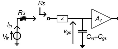
Figure F-4 : Simplification du circuit pour le calcul du coefficient de surtension
