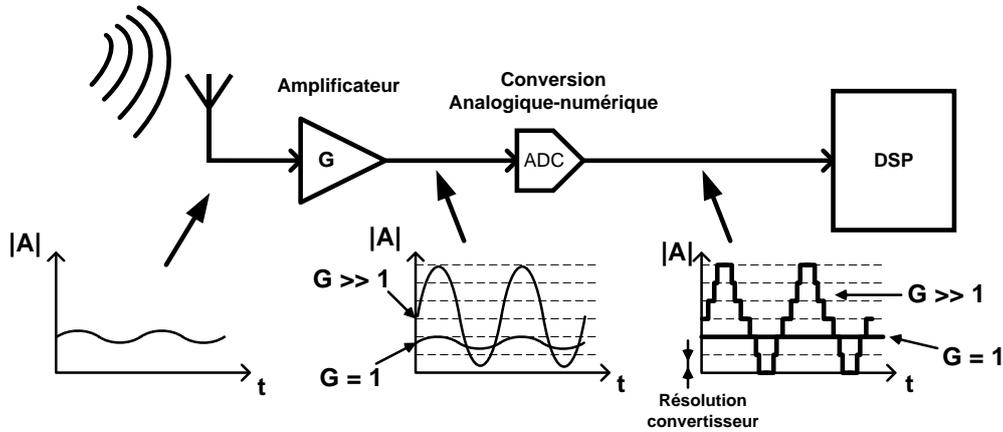
Figure I-15 Amplification d'un signal et résolution du convertisseur
