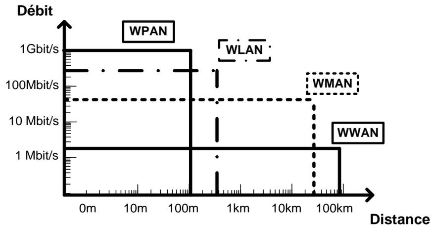
Figure I-20 Topologies des différents réseaux sans fil
