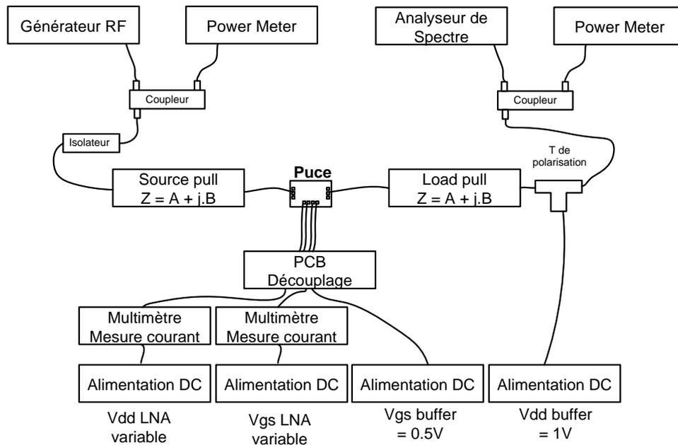
Figure III-28 Système de mesure à impédance variable
