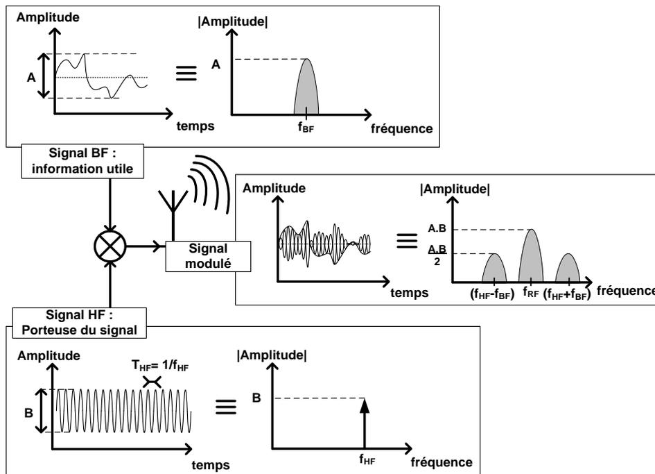
Figure I-3 Principe de la modulation d'amplitude (AM)
