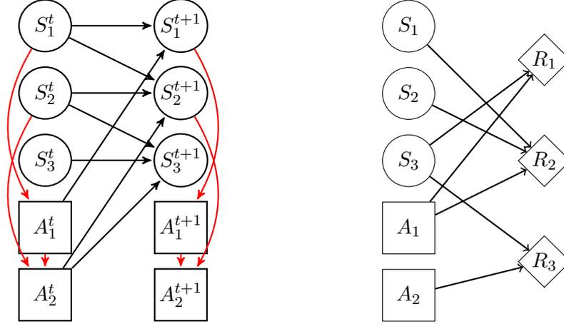
FIGURE 2.1 – Exemple de PDMF<sup>3</sup> correspondant au PDMF-AF à récompense additive de la figure 1.6 auquel ont été ajoutées en rouge les flèches correspondant à une structure de politique donnée :  $pa_\delta(A_1) = \{S_1\}$ ,  $pa_\delta(A_2) = \{S_2, A_1\}$ ; à gauche le réseau bayésien dynamique représentant la structure de la transition et des politiques, à droite la représentation graphique de la structure de la récompense.
