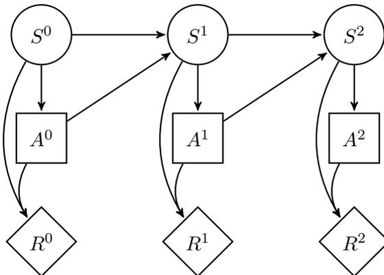
FIGURE 1.1 – Représentation d'un PDM d'horizon  $T = 2$  sous forme de diagramme d'influence (pour une politique markovienne)
