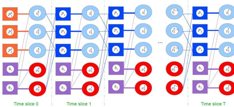
FIGURE 2.3 – Exemple de *factor graph* représentant la distribution  $P_\delta^T((s, a)^{0:T})$  du PDMF<sup>3</sup> de la figure 2.1 ; dans un *factor graph* les variables sont représentées par des cercles et les facteurs par des carrés
