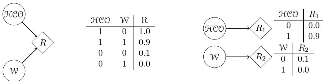
FIGURE 1.4 – Représentation de la fonction de récompense  $R$  du problème *Coffee Robot* sous deux formes équivalentes. La première, avec le diagramme et le tableau de gauche, montre de quelles variables d'état dépend la récompense et énumère toutes les combinaisons possibles de ces deux variables dans une table. La seconde représente la décomposition additive de la fonction de récompense, plus compacte :  $R(S^t, A^t) = R_1(\mathcal{HCO}^t) + R_2(W^t)$ .
