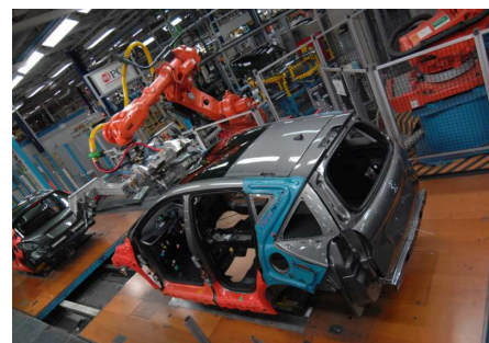
Figure I-5 : Pose automatisée du pare-brise
