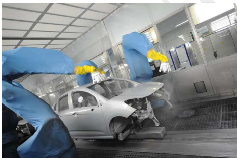
Figure I-4 : Pose des laques par des robots
