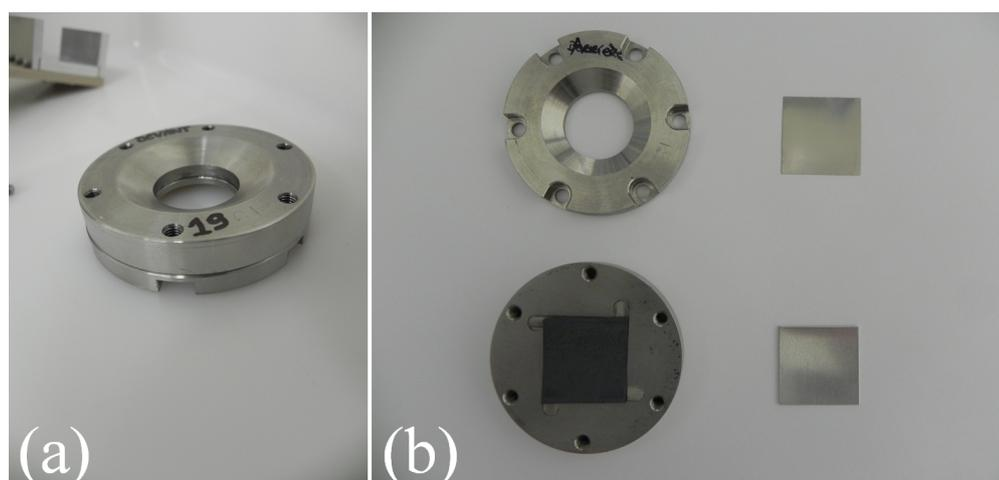
FIGURE 2.8 – Capsule fermée à gauche (a) et feuilles minces de 25 mm \* 25 mm (625 mm<sup>2</sup>) prêtes à être placées dans la capsule, à droite (b).
