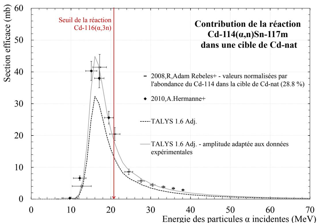
FIGURE 4.11 – Données de section efficace de production de l'étain-117m par la réaction  $Cd-114(\alpha,n)$  normalisées en supposant une cible de cadmium naturel dont l'abondance isotopique en  $Cd-114$  est 28.8 %. Adaptation des résultats TALYS en guise d'ajustement des données expérimentales.
