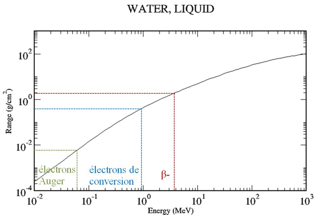
FIGURE 4.4 – Parcours des électrons dans l'eau pour des énergies allant de 10 keV à 1 GeV.
