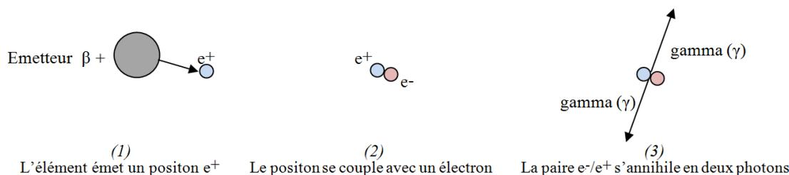
FIGURE 1.5 – Schéma du principe de l'annihilation  $e^+/e^-$ .
