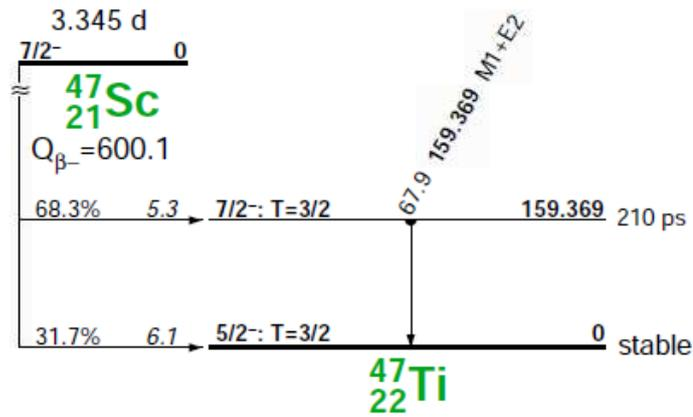
FIGURE 3.1 – Schéma de décroissance du scandium-47.
