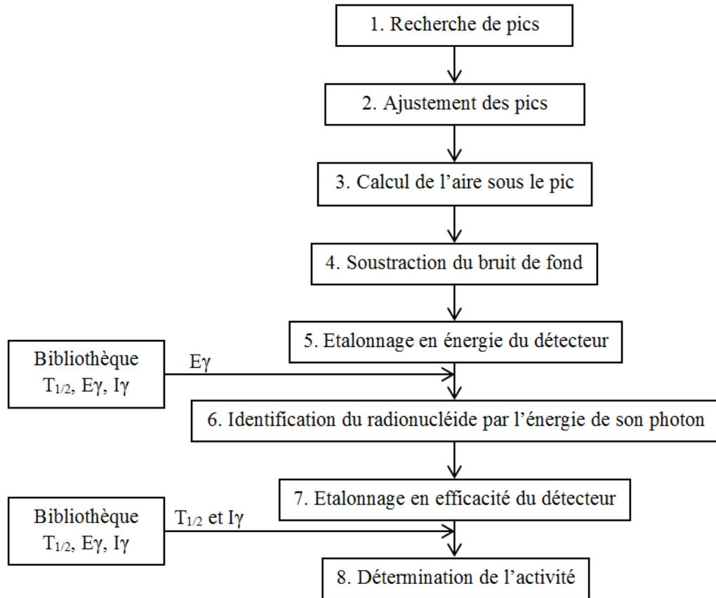
FIGURE 2.21 – Etapes permettant de déduire l'activité d'un radionucléide par spectrométrie  $\gamma$ .
