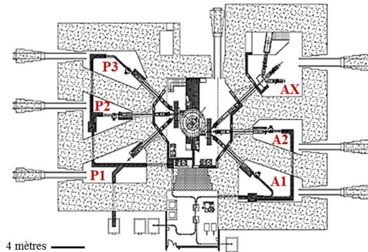
FIGURE 1.15 – Lignes faisceaux du cyclotron ARRONAX et ses casemates.
