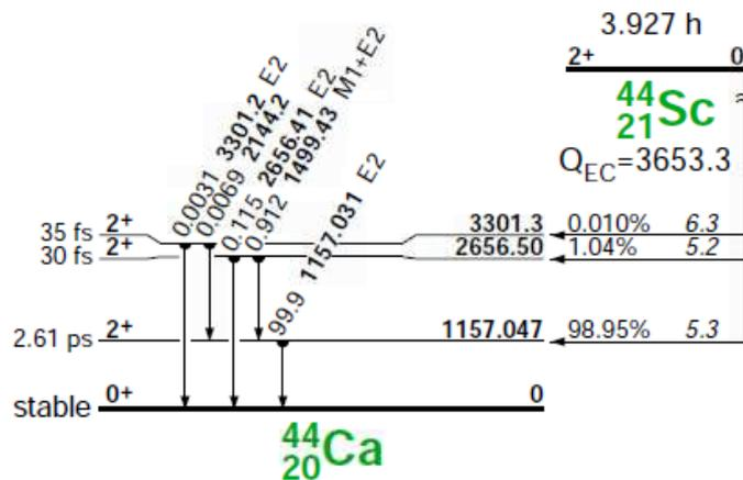
FIGURE 3.3 – Schéma de décroissance de l'état fondamental du scandium-44.
