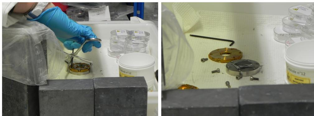
FIGURE 2.11 – Le démontage de la capsule après irradiation.
