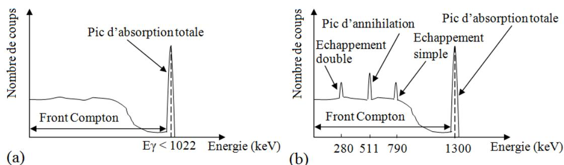
FIGURE 2.19 – Schéma de spectres obtenus en spectrométrie gamma dans le cas de la détection d'un photon d'énergie inférieure à 1022 keV (a) et supérieure à 1022 keV (b).
