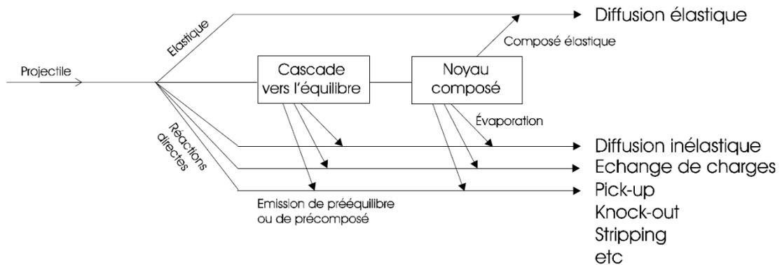
FIGURE 1.11 – Schéma extrait de la thèse de Benck S. [94] pour la représentation des processus de diffusion élastique, de réaction directe et de pré-équilibre lors d'une réaction nucléaire. Pour les noyaux lourds, il faut ajouter au noyau composé la possibilité de fissionner.
