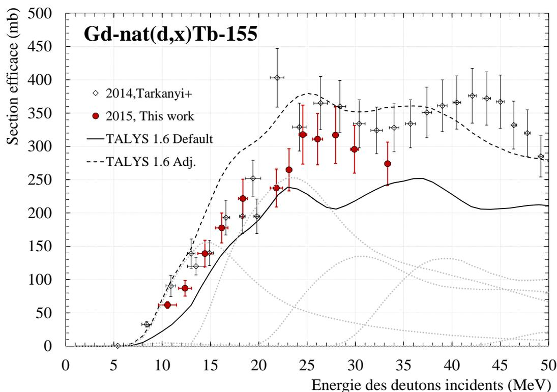
FIGURE 4.17 – Section efficace de production du Tb-155 par la réaction  $Gd\text{-nat}(d,x)$ . Comparaison avec les données présentes dans la littérature et du code TALYS 1.6. Les contributions de chaque voies de réactions sont représentées en lignes pointillés et proviennent des résultats du code TALYS 1.6 Adj.
