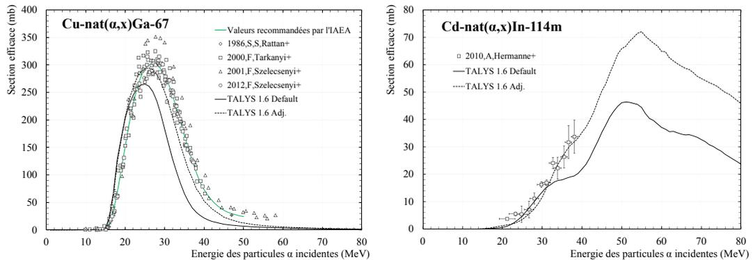
FIGURE 2.28 – Comparaison des résultats de TALYS 1.6 Adj. et TALYS 1.6 Default pour les sections efficaces liées aux réactions  $Cu\text{-nat}(\alpha,x)Ga\text{-67}$  (à gauche) et  $Cd\text{-nat}(\alpha,x)In\text{-114m}$  (à droite).
