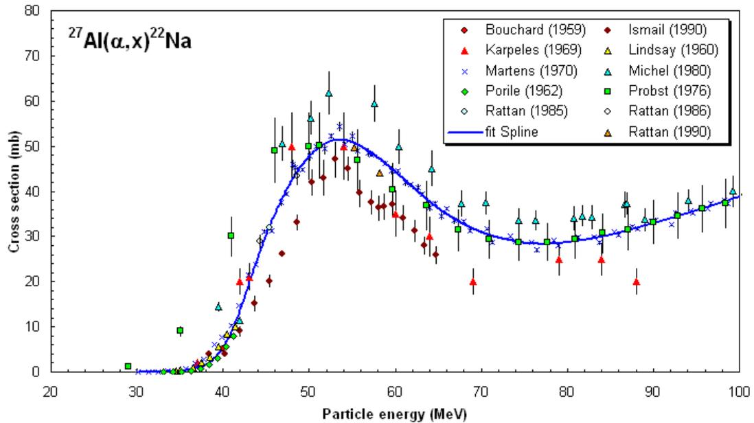
FIGURE 2.5 – Section efficace de production du Na-22 recommandée par l'IAEA, parla réaction Al-nat( $\alpha,x$ ) [114].
