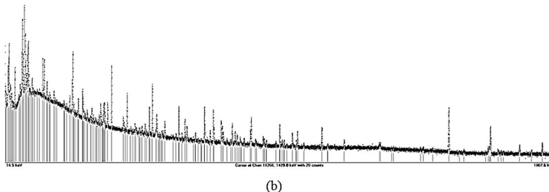
FIGURE 2.20 – (a) Spectre acquis le lendemain de l'irradiation d'une cible de  $\text{Ca-44CO}_3$  par un faisceau de deutons de 34 MeV. (b) Spectre acquis quatre jours après l'irradiation d'une cible de thorium-232 par des deutons de 34 MeV.
