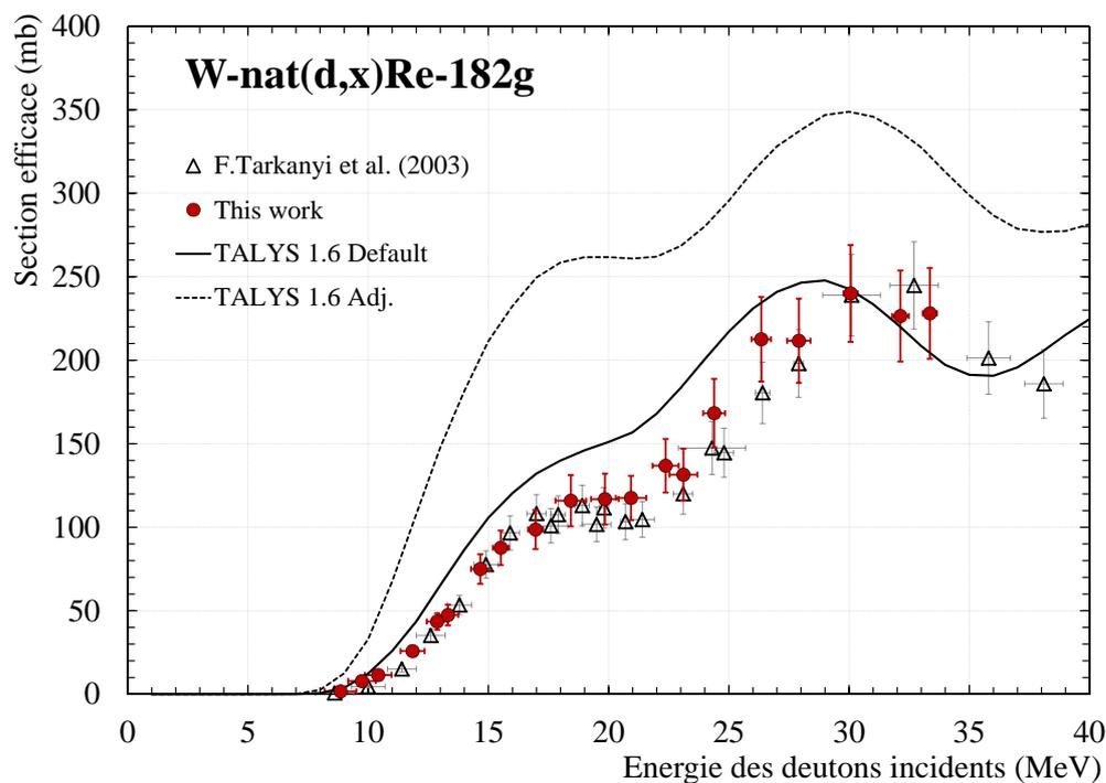
FIGURE I.2 – Section efficace de production du Re-182g via la réaction  $W\text{-nat}(d,x)Re\text{-182g}$ .
