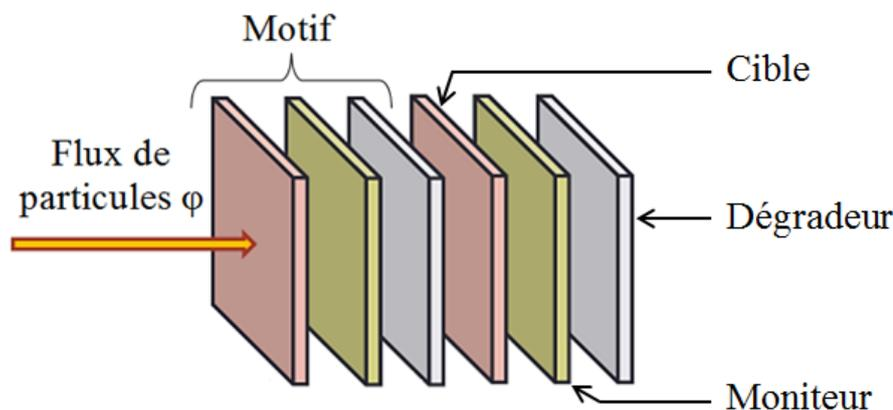
FIGURE 2.1 – Vue schématique de la technique des "stacked-foils".
