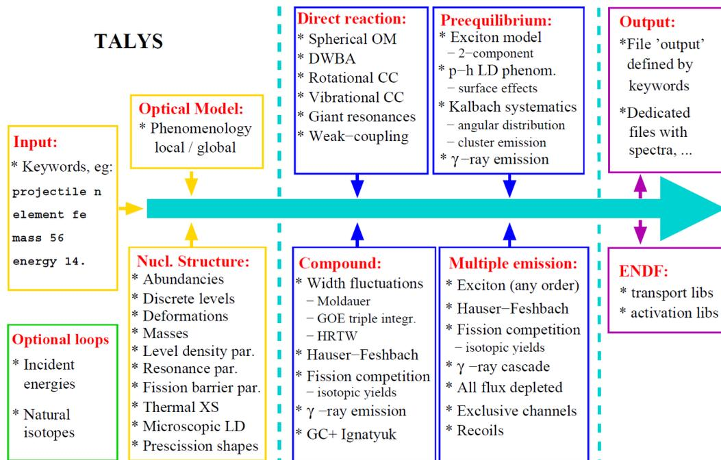
FIGURE 2.25 – Schéma de la structure de TALYS.
