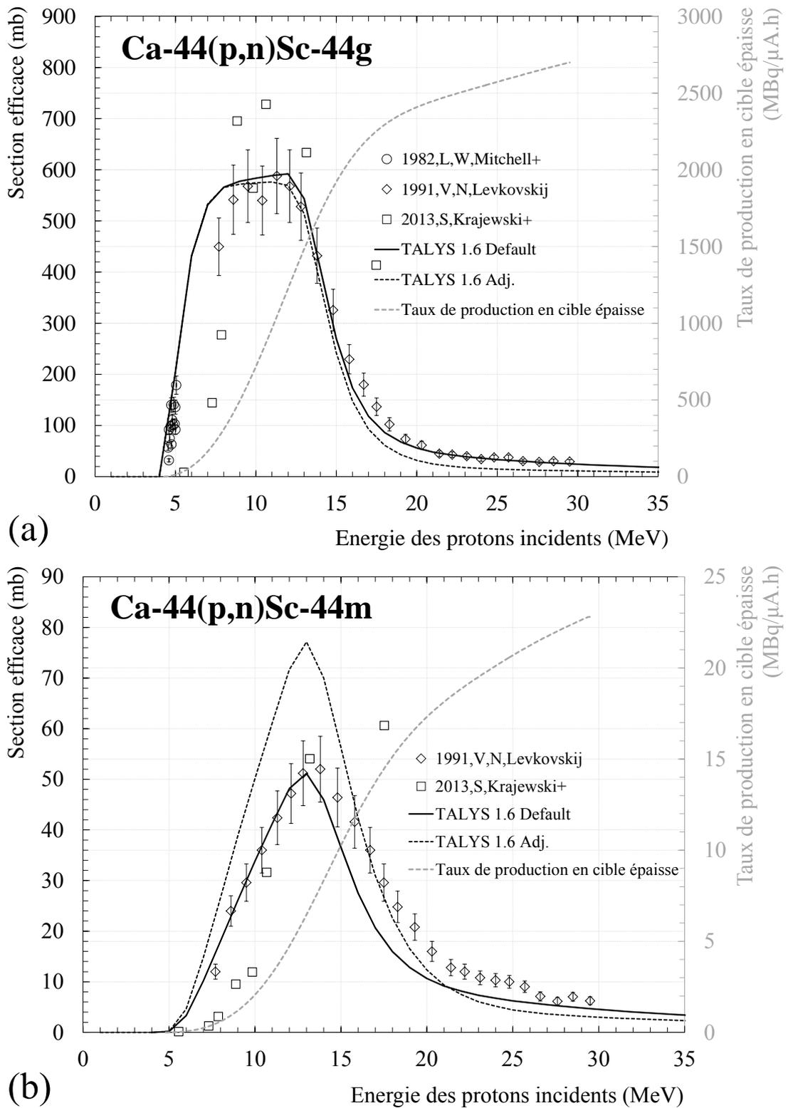
FIGURE 3.5 – Sections efficaces pour la réaction  $Ca-44(p,n)Sc-44g$  (a) et la réaction  $Ca-44(p,n)Sc-44m$  (b), comparées avec le code TALYS. Taux de production en cible épaisse associés aux valeurs expérimentales.
