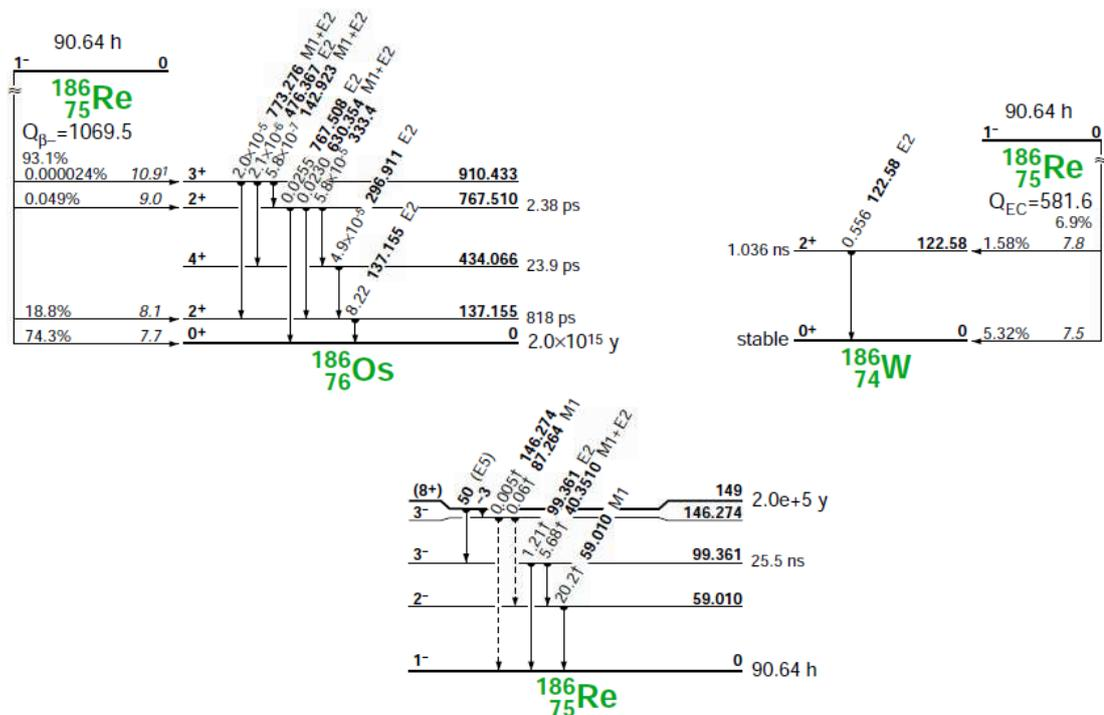
FIGURE 4.5 – Schéma de décroissance du Re-186g.
