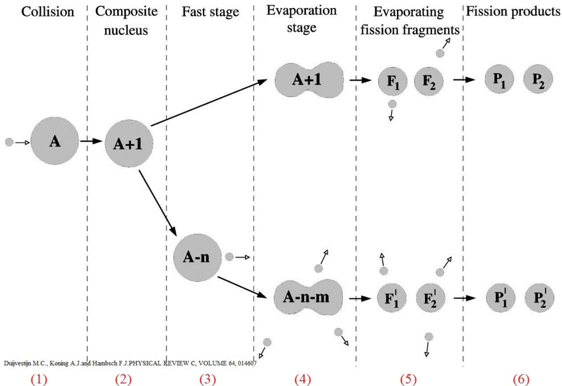
FIGURE 6.3 – Schéma décrivant la différence entre deux processus de fission : "first-chance process" et "multi-chance process" (issu de l'article de Duijvestijn M.C., Koning A.J. and Hamsch F.J. Physical Review C, Vol. 64, 014607).
