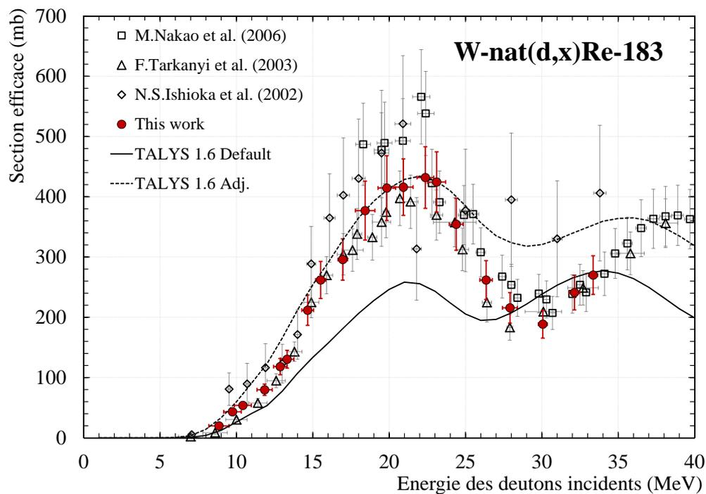
FIGURE I.1 – Section efficace de production du Re-183 via la réaction  $W\text{-nat}(d,x)Re\text{-183}$ .
