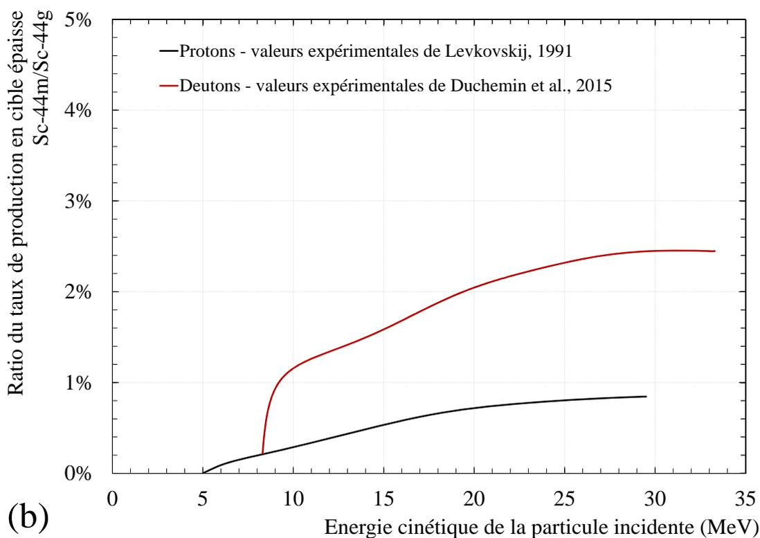
FIGURE 3.12 – Ratio des sections efficaces de production expérimentales  $\sigma(\text{Sc-44m})/\sigma(\text{Sc-44g})$  (a) et des taux de production en cible épaisse (b) en utilisant des protons et des deutons comme projectiles.
