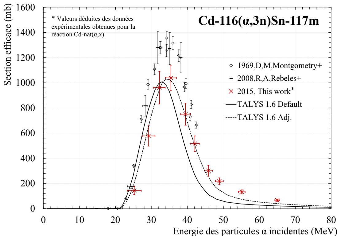
FIGURE 4.12 – Données de section efficace de production de l'étain-117m calculées pour la réaction  $Cd-116(\alpha,3n)$  à partir des données expérimentales obtenues pour la réaction  $Cd-nat(\alpha,x)Sn-117m$ .
