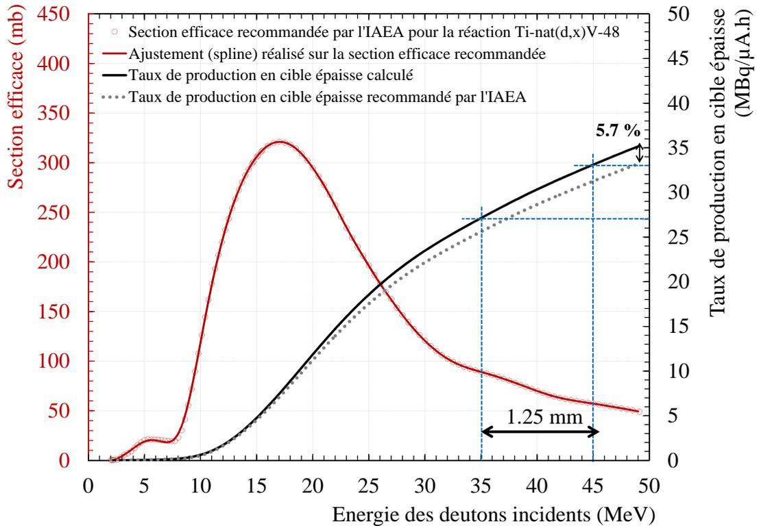
FIGURE 2.24 – Taux de production en cible épaisse pour la réaction  $Ti\text{-nat}(d,x)V\text{-48}$ . Comparaison entre le programme de calcul développé au cours de la thèse de E. Garrido [112] et les valeurs recommandées par l'IAEA.
