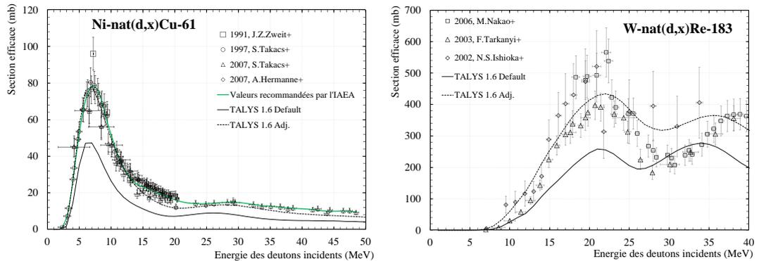
FIGURE 2.27 – Comparaison des résultats de TALYS 1.6 Adj. et TALYS 1.6 Default pour les sections efficaces liées aux réactions  $Ni\text{-nat}(d,x)Cu\text{-61}$  (à gauche) et  $W\text{-nat}(d,x)Re\text{-183}$  (à droite).
