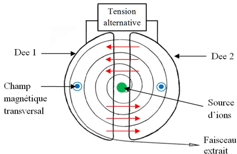
FIGURE 1.14 – Schéma de fonctionnement d'un cyclotron.
