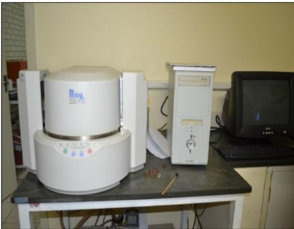
**Photo 6.7.** Appareil marque : Spectromètre SHIMADZU RAY ry-EDX-700 HS, avec energie dispersive – rayon X.
