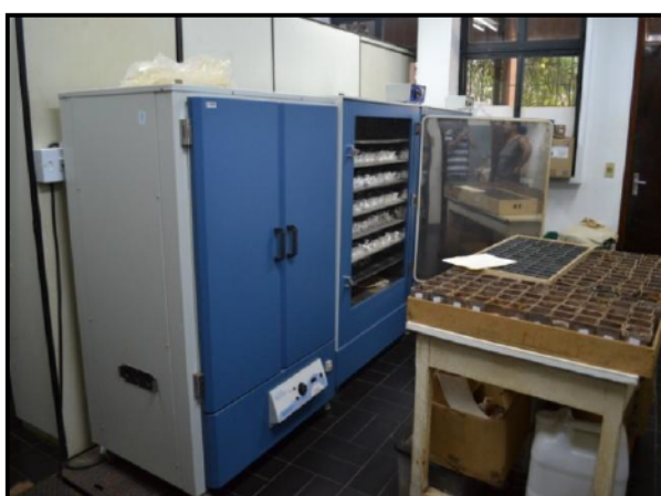
Photo 6.2. Etuve pour le séchage et stérilisation des sols TR 1050 300°C.
