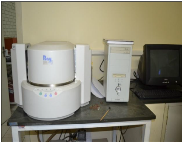
Photo 6.7. Appareil marque : Spectromètre SHIMADZU RAY ny-EDX-700 HS, avec energie dispersive – rayon X.
