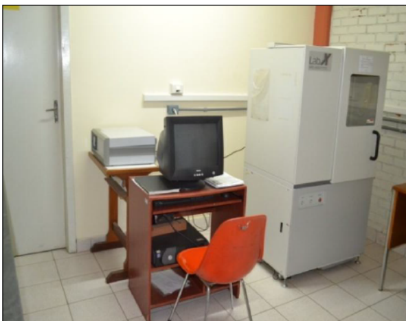
Photo 6.8. Diffractomètre Marque : LAB X - XRD 6000 SHIMADZU. Nous utilisons l'Azote liquide.
