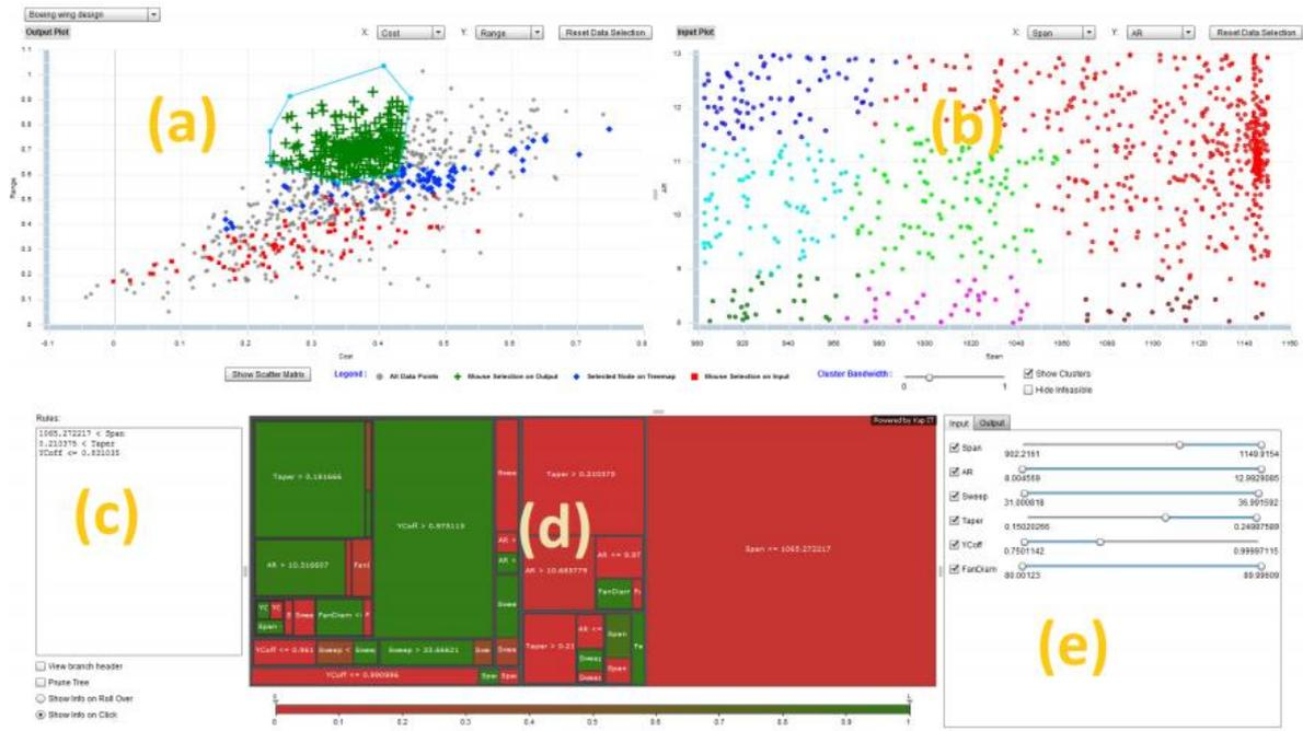
Figure 16 : Impressions d'écran de l'outil LIVE: (a) scatter plot des variables de performance; (b) scatter plot des paramètres de conception (montrant des clusters de résultats); (c) règles de décision; (d) treemap de l'arbre de décision; (e) sliders ajustables des intervalles des variables.
