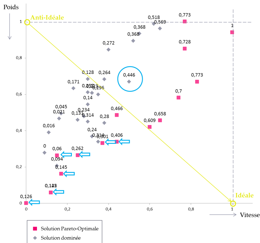
Figure 75 : Carte des indices pour le scénario PUISSANCE avec « vitesse » à maximiser et « poids » à minimiser
