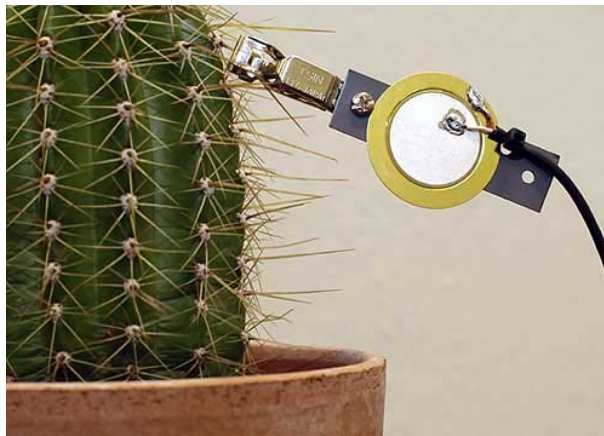
FIGURE 3.12: Certains bioacousticiens, audionaturalistes ou artistes d'art audio comme Michael Prime travaillent de manière inusitée en convertissant en sons les champs bioélectriques émis par des végétaux ou des champignons. Des capteurs permettant de basculer les énergies bioélectriques dans le monde de l'audible
