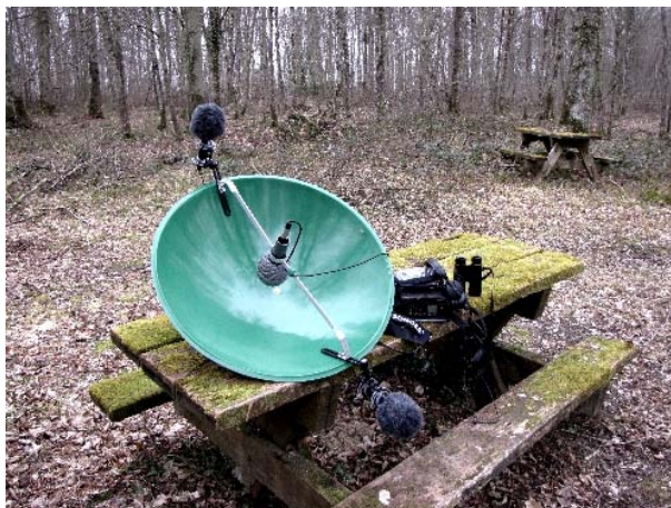
FIGURE 3.9: Parabole avec deux micros omnidirectionnels (photo Fernand Deroussen)
