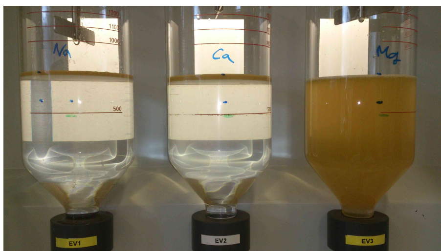
Figure 8.18 – Floculation-flottation induite par ajout de diverses bases (de gauche à droite : soude, chaux, hydroxyde de magnésium). Concentrations de bases par litre de suspension algale initiale : 0.01 \text{ mol.L}^{-1} .
