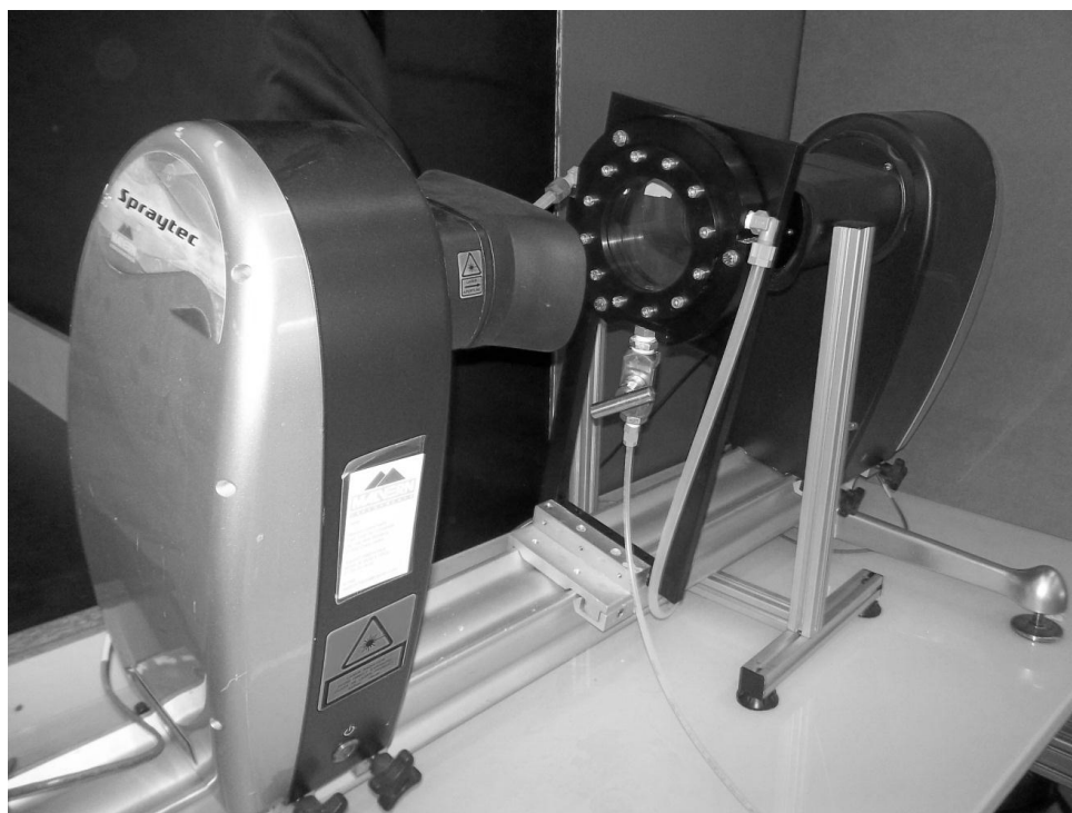
Figure 9.5 – Malvern Spraytech™ couplé avec la cellule de visualisation conçue dans cette étude, pour mesurer la distribution de taille des bulles produites par DAF
