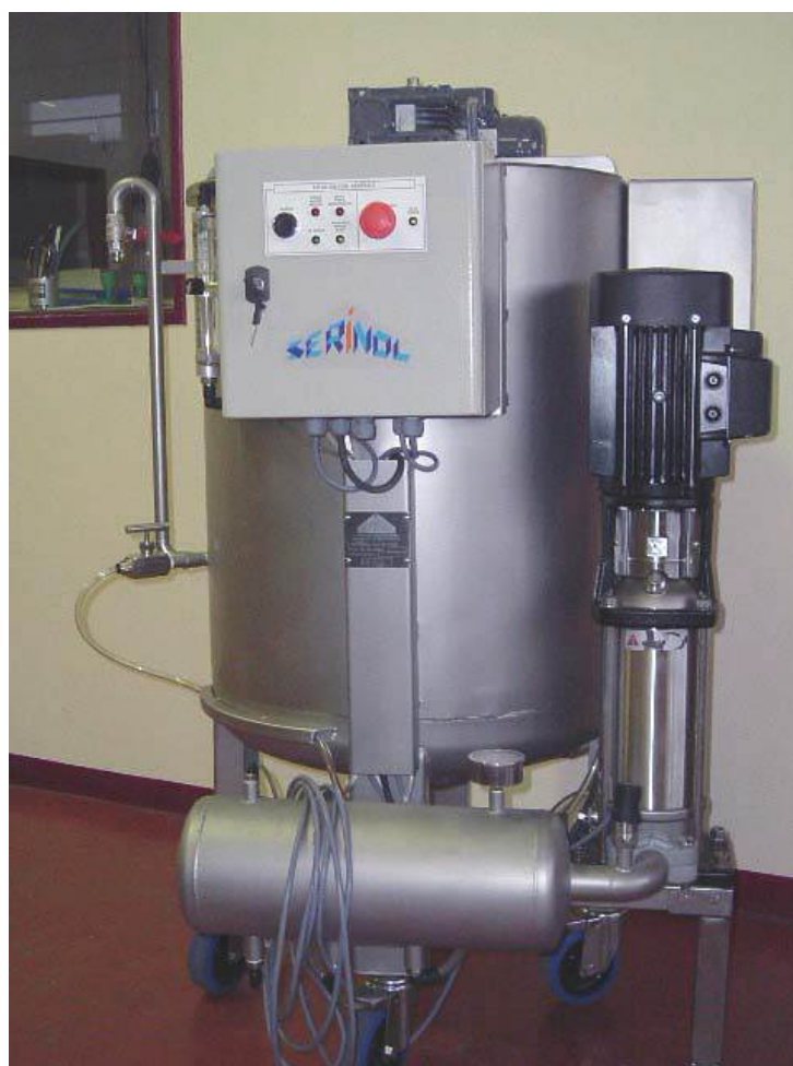
Figure 9.1 – Photo du flottateur CY1 de Sérinol avant modifications.
