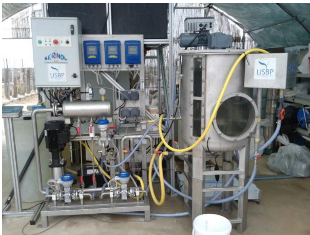
Figure 9.3 – Photo du flottateur CY1 de Sérinol après modifications.
