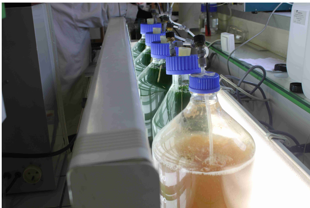
Figure 4.2 – Photo de la plateforme de culture, avec la double rampe d'éclairage mais sans les dispositifs de limitation du pH.
