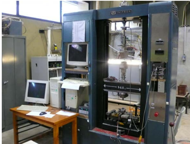
Figure 3-4. Presse électromécanique pour essais de traction
