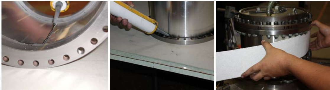
Figure 3-1. Etapes de fabrication des coques roulées-collées.
