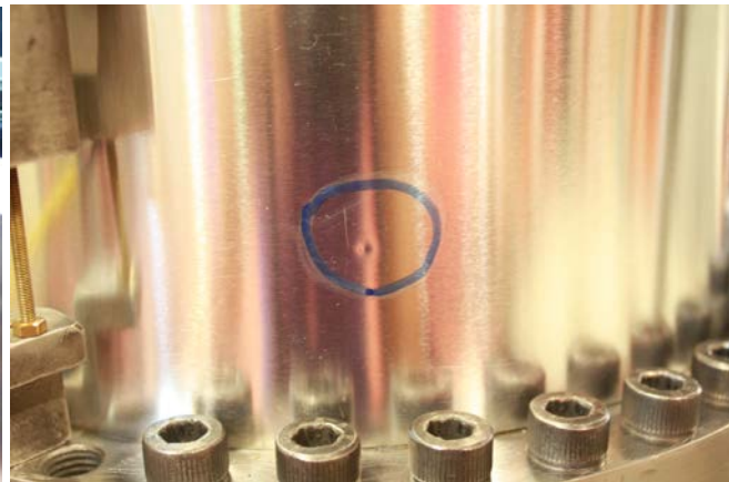
b) Défaut local de fabrication. Aluminium t = 0.2\text{mm}
