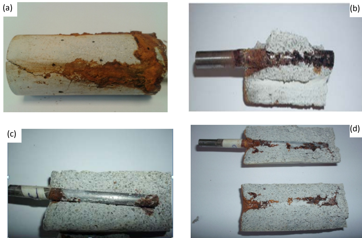
Figure V. 17 : Observations de la surface d'acier enrobé du mortier témoin ( E_pT ) (a, b), de mortier malaxé avec l'inhibiteur \text{Na}_3\text{PO}_4 ( E_p5P ) (c) mortier adjuvanté avec \text{Na}_3\text{PO}_4 + \text{NaCl} ( E_p5PCL ) (d) à la fin des cycles C_1 (a, b et d) et cycle C_2 (c).
