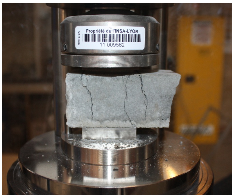
Figure II. 31: Schéma de l'essai de la résistance à la compression.
