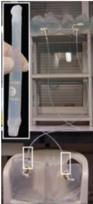
Figure 18. Photographie de l'installation nécessaire à la préconcentration (ici deux préconcentrations simultanées). Les rectangles blancs indiquent la position des colonnes NTA. La colonne NTA est grossie sur le coin supérieur gauche, où l'on peut apercevoir les 2 frittés. D'après Lacan et al. (2010).
