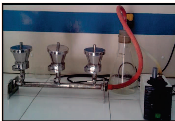
Figure 1 : Rampe de filtration en acier inox
