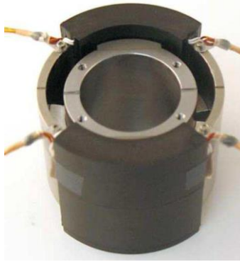
a) Moteur a débattement limité (LAT) (source :[68]) : Domaines thermique et électromagnétique
