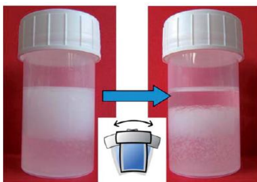
Figure III. 9 : Séparation de phase provoquée par une faible agitation d'une émulsion stabilisée par des microgels composés de 5 %mol de réticulant. Extrait de 22 .
