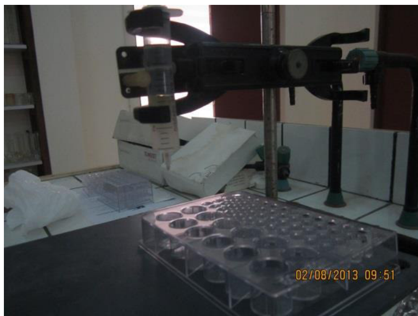
Figure 13: Dispositif utilisé pour le fractionnement des huiles essentielles
