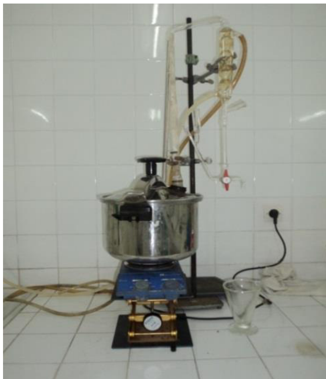
Figure 12: Dispositif d'extraction d'huile essentielle de type Clevenger utilisé pour l'extraction des huiles essentielles
