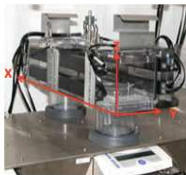
Figure 43 : Cages de calorimétrie indirecte pour souris (Comprehensive Lab Animal Monitoring System ((CLAMS), Columbus Instruments, Ohio, USA) : schématisation des axes de quantification de l'activité des souris.
