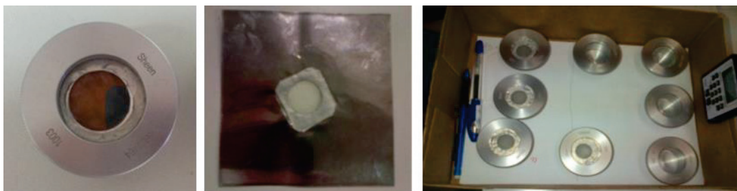
Figure 36 : Illustration de la méthode de quantification de la perméation des films à la vapeur d'eau
