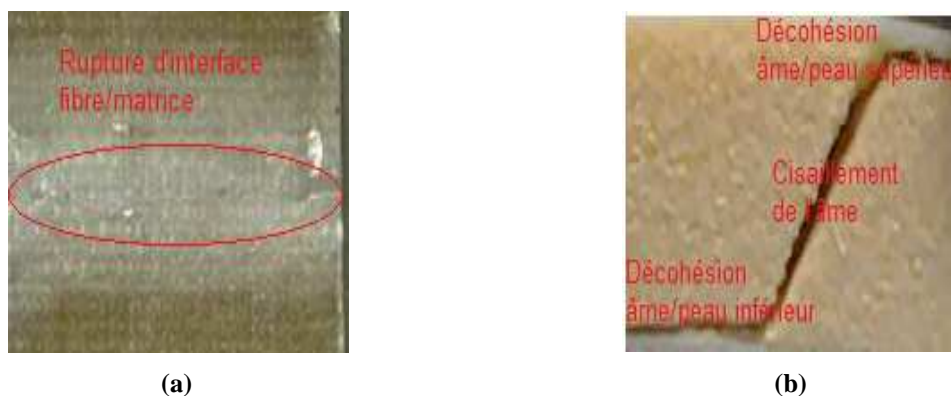
Figure 5.5 Ruptures du matériau sandwich : a) rupture de la peau et b) rupture par décohésion peau/âme
