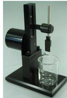
Figure A-III-2 : Dispositif de trempage retrait.
