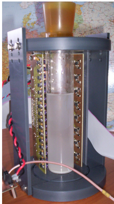
FIGURE 4.1 – Le tube de mesure du SCAF dans la structure : la carte d'émission est visible à gauche, la réception à droite.
