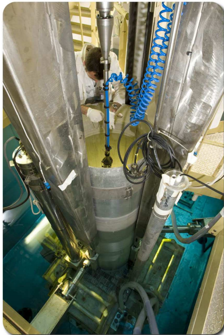
(a) Photographie du cœur de MINERVE, on peut voir la canne d'oscillations au-dessus du cœur, qui insère et extrait alternativement les différents échantillons au centre du cœur.
