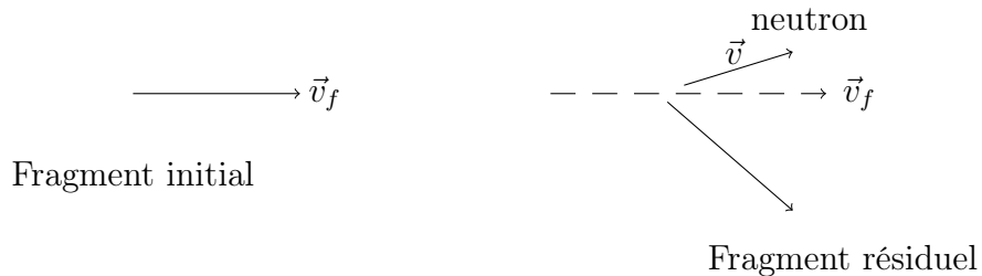
FIGURE 2.2 – Schéma de l'émission d'un neutron par un fragment, dans le référentiel du laboratoire.
