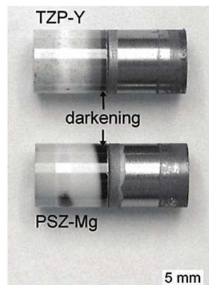
Figure 26 : Brasures  $\text{ZrO}_2/\text{Ag-28Cu/TA6V}$  après un cycle à  $820^\circ\text{C}$  [118]
