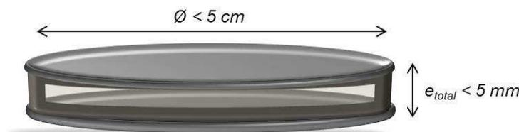
Figure 4: Schéma du boîtier proposé
