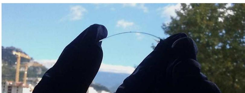
*Figure 99: Flexion d'un demi-boitier hermétique*
