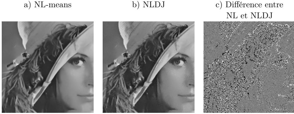
FIGURE 5 – Illustration du de-jittering . a) Solution des NL-means classiques, b) Solution des NL-means de-jittered , et c) Différence entre les deux solutions.
