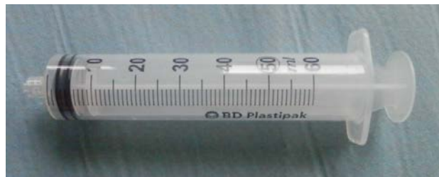
Figure 3 : Photo d'une seringue Becton Dickinson Plastipack 50 mL luer verrouillable (référence 300865)
