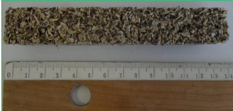
*Figure 55 : Exemple d'échantillon composite découpé à la scie à ruban pour des analyses en traction*
