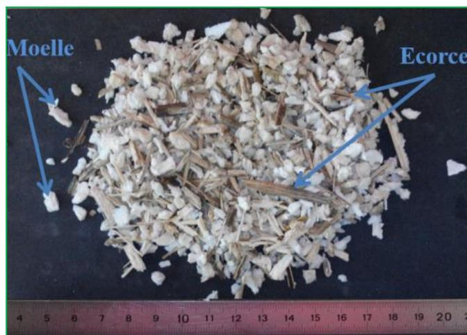
Figure 41 : Broyats de tiges de tournesol de granulométrie comprise entre 3 et 5 mm
