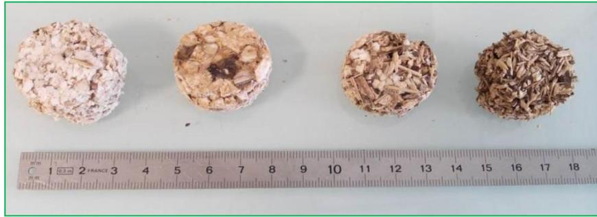
*Figure 65 : Echantillons de composites (chitosane/broyats de tiges de tournesol) préparés pour des mesures acoustiques*
