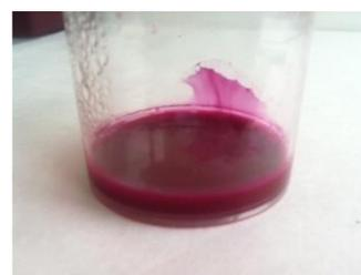
*Figure 85 : Marquage du chitosane à la rhodamine isothiocyanate pour le suivi de pénétration dans le renfort*
