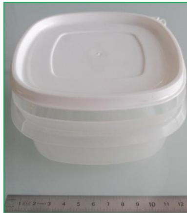
*Figure 39 : Moule en polypropylène utilisé pour la préparation de films de chitosane*
