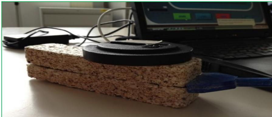
**Figure 63 : Mesure de la conductivité thermique au sein d'un composite à l'aide du Fil Chaud**
