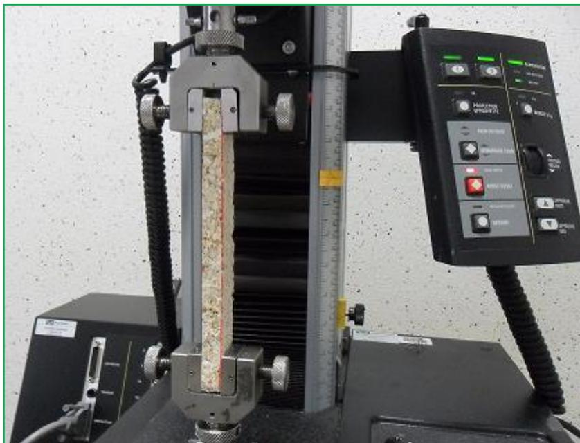
*Figure 56 : Dispositif de mesure en traction d'un composite*
