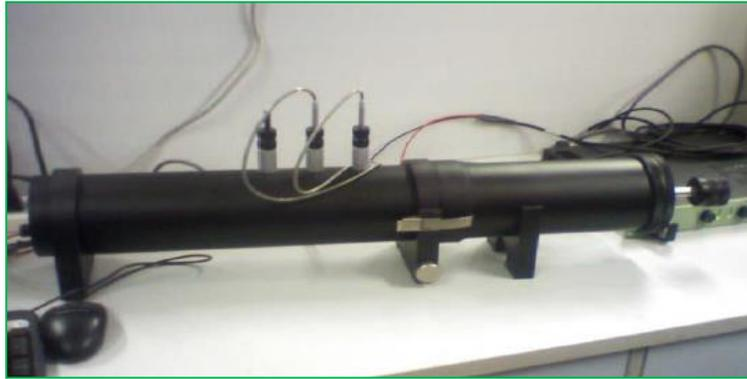
*Figure 64 : Dispositif du tube d'impédance (El Hajj et al, 2011)*
