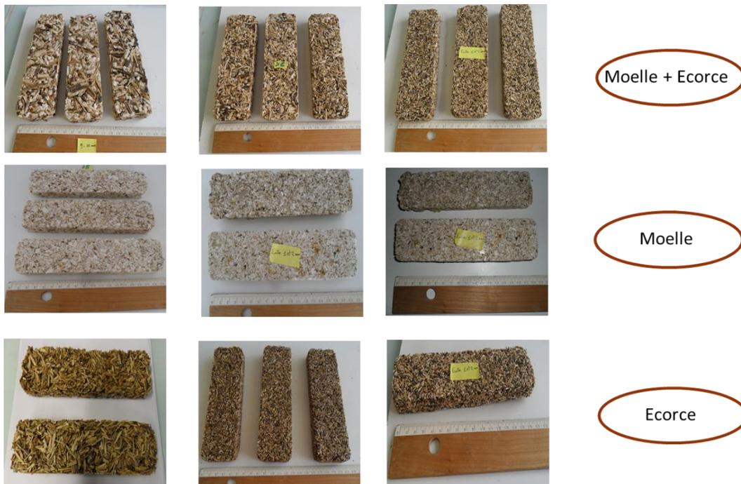
*Figure 87 : Composites "chitosane/broyats", "chitosane/moelle" et "chitosane/écorce" préparés pour les mesures de porosités*
