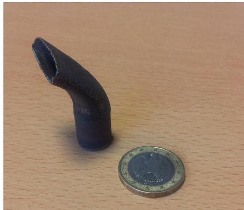
Figure 5.11 – Pièce finale réalisée en fabrication additive par projection de poudres métallique
