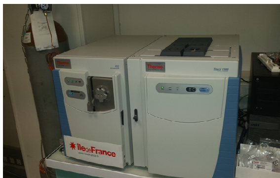
Figure 2.3. Chromatographie en phase gazeuse couplée à la spectrométrie de masse (GC-MS)
