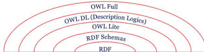
FIGURE 2.7 – Inclusions des fonctionnalités des différents langages du web sémantique. Extrait de http://www.w3.org/2005/Talks/1111-Delhi-IH/ (dernier accès le 17/07/2015)
