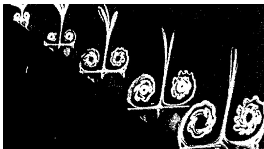
FIGURE 5.13 – Visualisation latérale par fumée de l'écoulement tourbillonnaire sur une aile delta de 80^\circ de flèche à \alpha = 20^\circ (Payne et al. , 1988)
