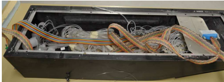
FIGURE 2.8 – Installation de tout le système de mesure de pression fluctuante à l'intérieur de la maquette, c'est-à-dire {capteur + tubes d'adaptation d'impédance + volume tampon + câbles électriques} pour les 32 capteurs, (Gouveia de Moraes, 2011)
