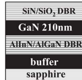
Figure 4.1 – Structure de la cavité GaN étudié par Christopoulos et al. 68 .
