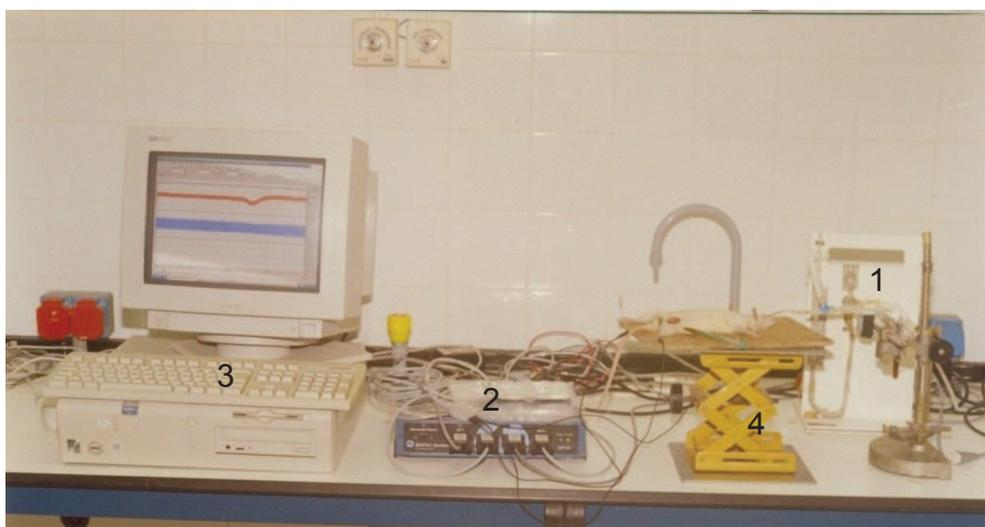
**Figure 13.** Dispositif d'enregistrement de la pression artérielle par voie directe. 1 : transducteur ; 2 Biopac « MP 35 » ; 3 : ordinateur ; 4 : potence réglable.
